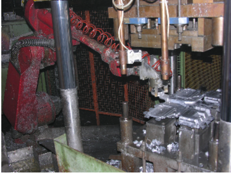
Şekil II.17 Dökülen Parçanın Kalıptan Alınması İşlemi
