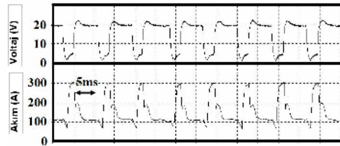
Şekil III.39 Yumuşak Çeliklerin Kaynağında Tipik Akım Dalga Şekli
