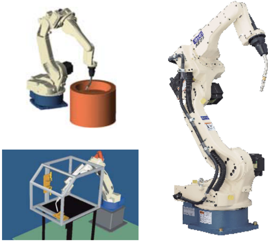
Şekil III.31 Kaynak Kabloları İçinden Geçecek Şekilde Tasarlanmış Kaynak Robotu
