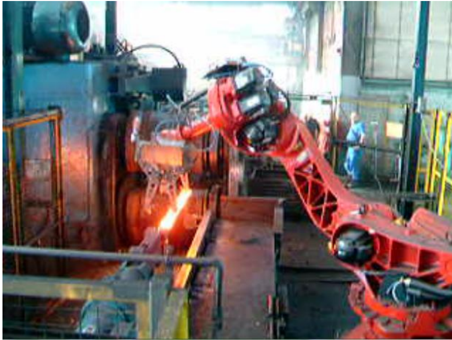
Şekil II.16 Dövme İşleminde Çıkan Malzemeyi Taşıyan Comau Marka Foundry Robot
