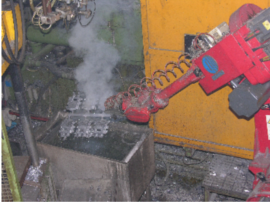
Şekil II.18 Kalıptan Parçanın Alınan Parçanın Soğutulması İşlemi
