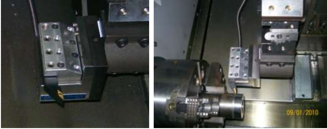
Şekil III. 10 Dinamometreye kesici uçun bağlanması ve işleme
