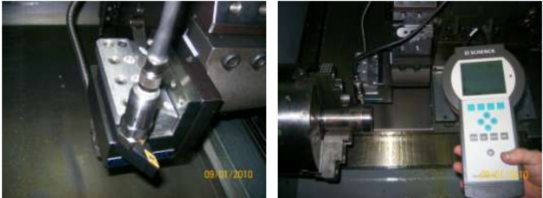
Şekil III. 13 Schenck VibroTest60 Cihazının Bağlanması ve Titreşim Ölçümü
