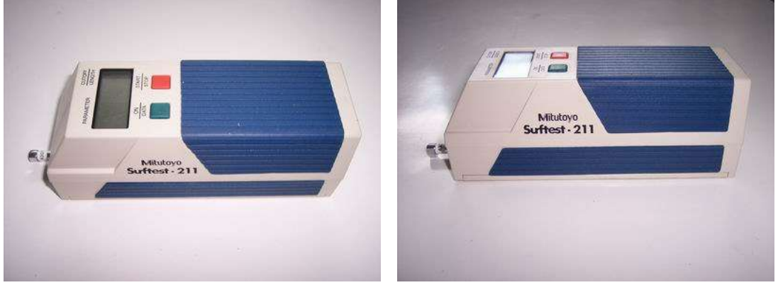
Şekil III. 14 Mitutoyo SurfTest S211 Yüzey Pürüzlülüğü Ölçüm Aleti
