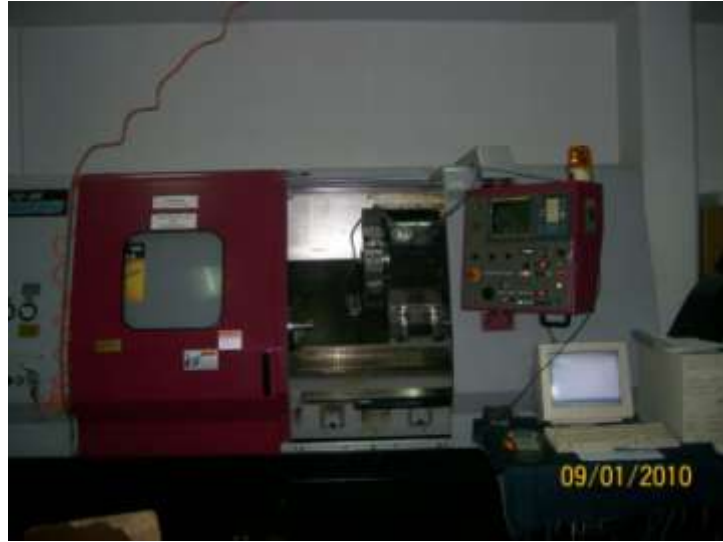
Şekil III. 7 JOHN FORD TC 35 CNC Torna Tezgahı
