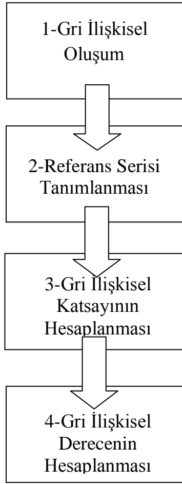
Şekil III. 6 Gri İlişkisel Yöntemi Hesaplama Adımları
