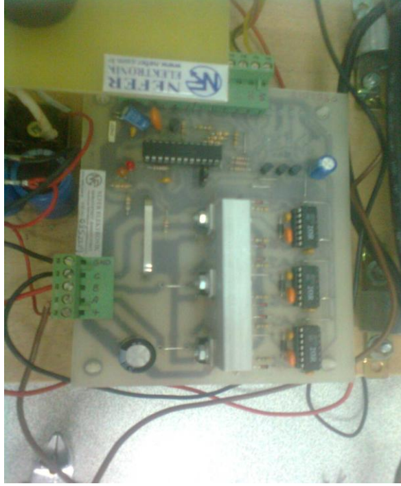
Şekil IV.67a Eski Bipolar-Unipolar Sürücü Devresi
