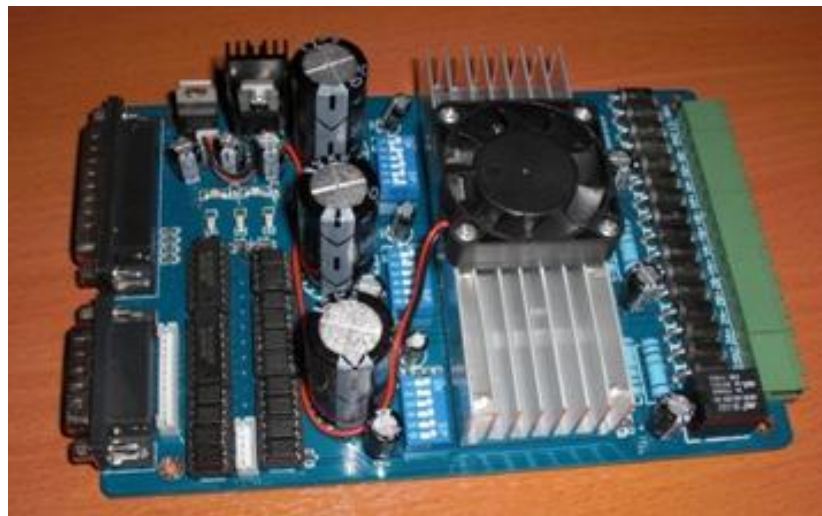
Şekil III.15: Toshiba TB6560 AHQ devresi
