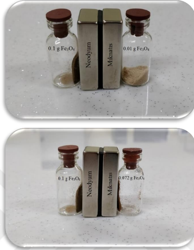
Şekil 4.7 Farklı miktarlarda Fe 3 O 4 nanopartikül içeren \beta -CD adsorbentlerin neodyyum miktatıyla etkileşimi.
