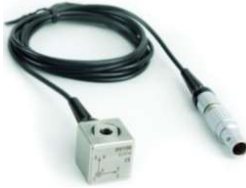
Şekil 3.5 Zemin tipi ivmeölçer (Svantek, 2017)
