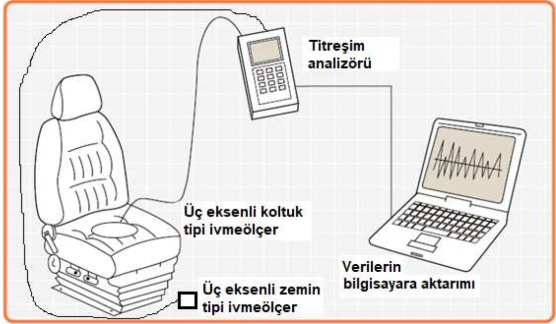
Şekil 3.2 Operatör koltuk yüzeyinde ve zeminde, koltuk dikmesi yanındaki ivmeölçerler ile X, Y ve Z eksenleri üzerinden yapılan TVT ölçümü (Mcphee, 2009'dan değiştirilerek)
