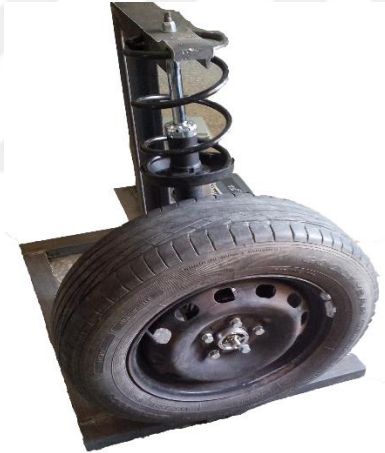
Şekil 4.6. Süspansiyon sisteminin gövde üzerine montajı
