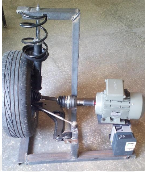
Şekil 4.7. Motor ve devir ayarlayıcının montajı
