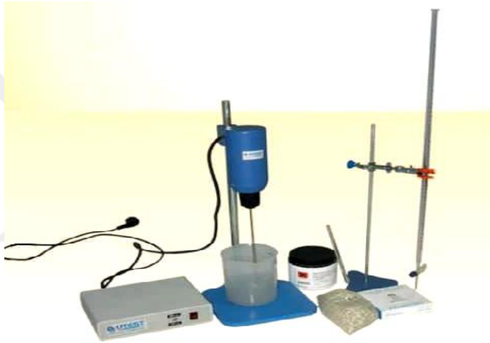
Şekil 3.3 Metilen mavisi deney seti
