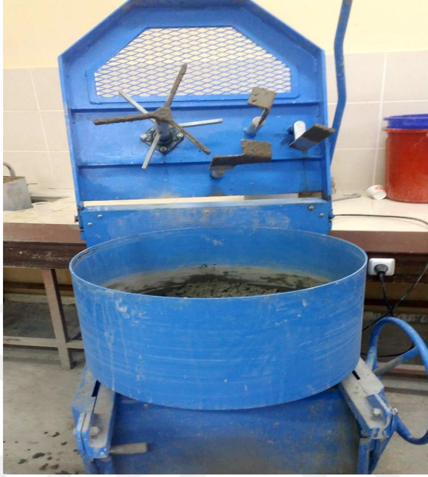
Şekil 3.4 Pan tipi beton mikseri
