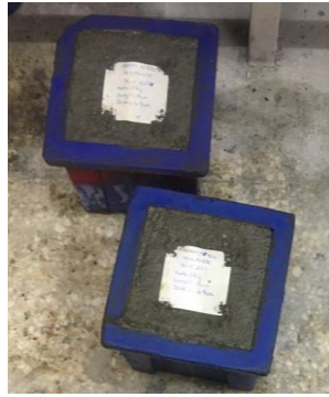
Şekil 3.6 Kalıplara alınan beton numuneleri
