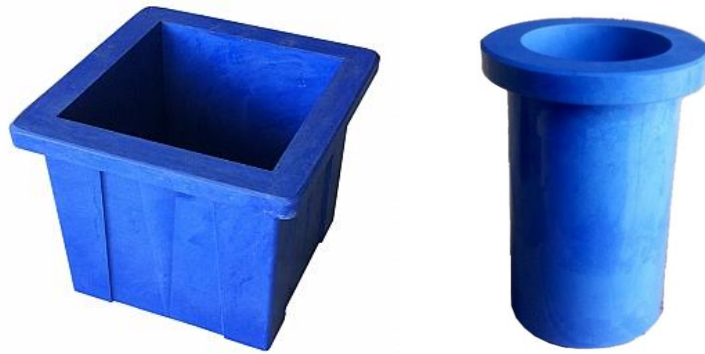
Şekil 2.5 Standart küp ve silindir şeklindeki beton kalıpları
