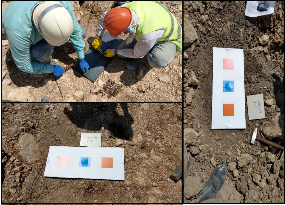
Şekil 6.6 Deformasyon Plakalarının Tesisi(Gül vd., 2018)
