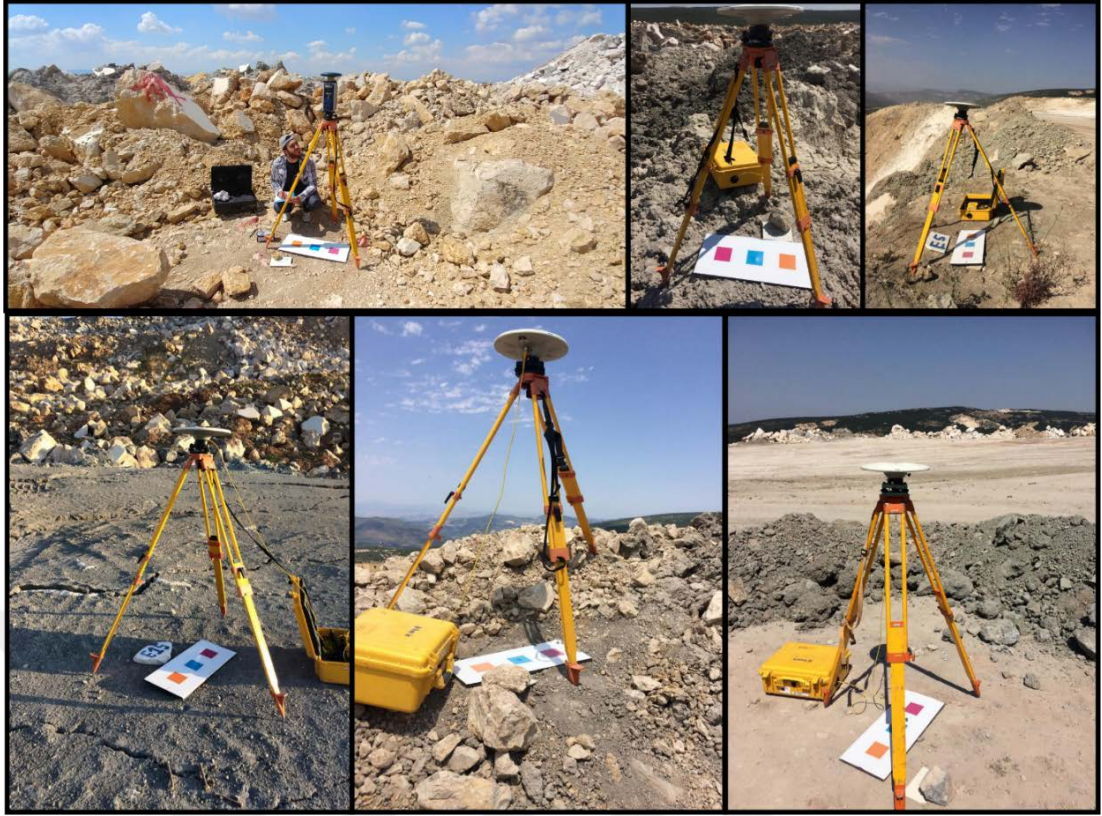
Şekil 6.7 Deformasyon Plakalarında Yapılmış Olan GNSS Ölçümleri
