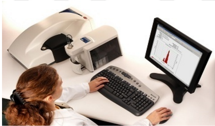
Şekil 2.2 Malvern Zetasizer Nano ZS partikül büyüklüğü ve zeta potansiyel ölçüm cihazı.
