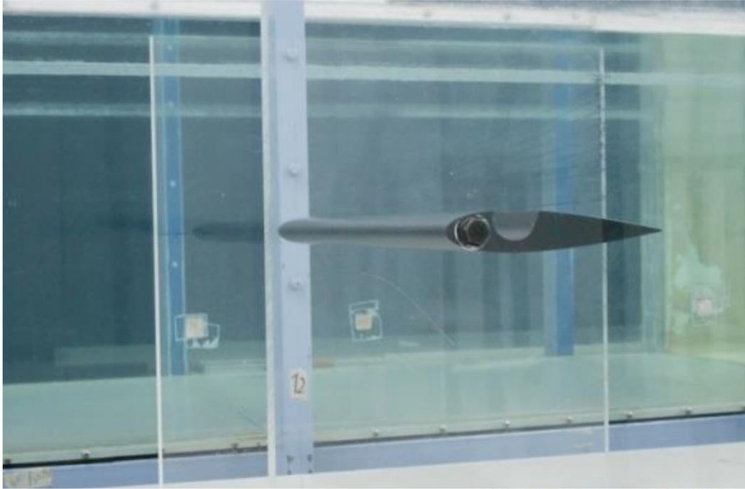
Şekil 3.9 Boşluklu kanat modelinin su kanalına yerleştirilmiş hali
