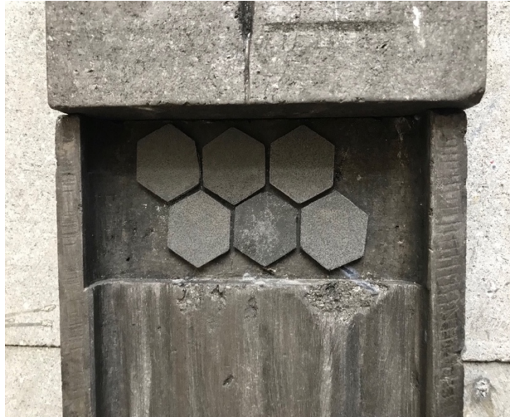
Şekil 4.11 Dökümde kullanılan grafit pota ve 2x3 dizilimdeki numuneler
