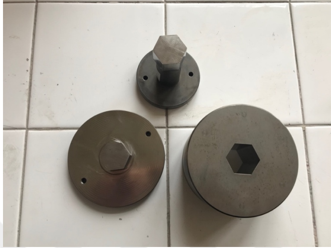
Şekil 4.5 Pres işleminde kullanılan metal kalıp
