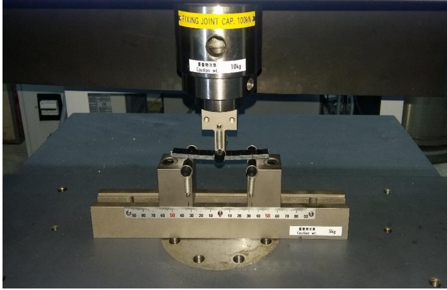
Şekil 3.15 Üç nokta eğme testinin yapılması.
