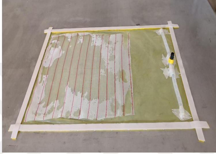
Şekil 3.7 Soyma kumaşının yerleştirilmesi.
