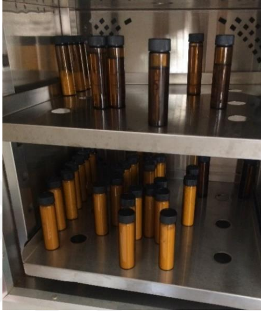
Şekil 3.10 Etüvde, amber renkli şişeler içerisinde keten tohumu yağı ve mikroenkapsüle keten tohumu yağı
