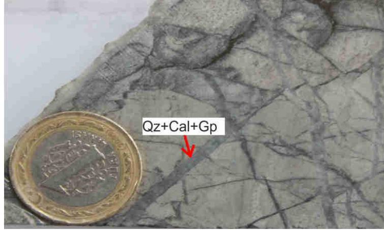
Şekil 6.3. Bir sondajdan alınmış karot örneğinde ağsı yapılı kuvars (Qz), kalsit (Cal) ve jips (Gp) içeren damarcıklar (Sondaj No: SZK-2 , 221. m; Örnek No: Sz-221)
