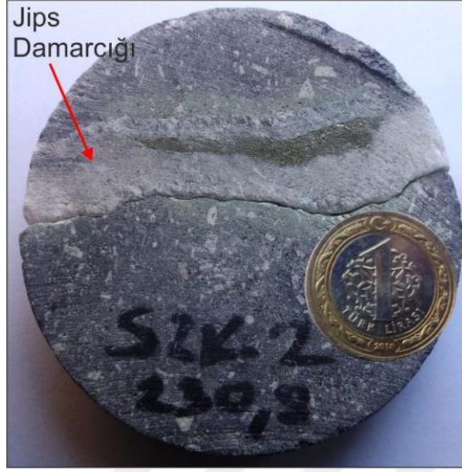
Şekil 6.5. Jips damarcığı ve pirit oluşumu (Sondaj No: SZK-2,230.9.m)
