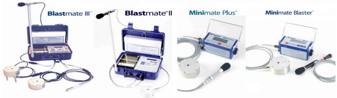
Şekil 3.4 Çalışmada kullanılan yer sarsıntısı ve hava şoku izleme cihazları (Anonim9, 2018).
