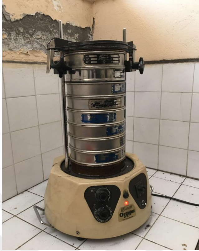
Şekil 13. Elek Analizi düzeneği.
