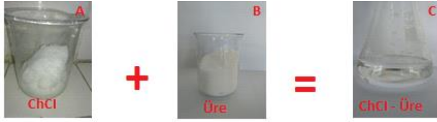
Şekil 21. Kaolin klorür- üre iyonik sıvısının hazırlık aşamaları fotoğrafları.
