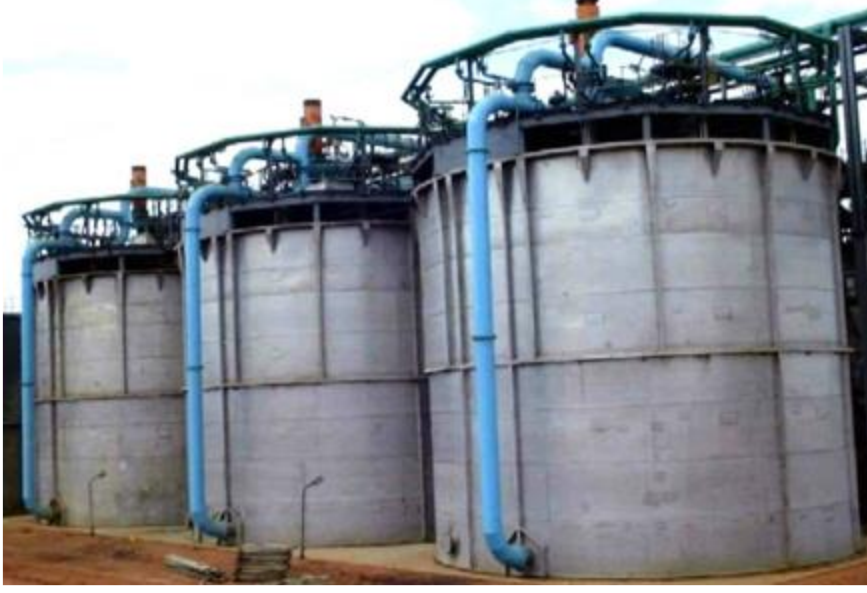
Şekil 11. Tank biyoliç çalışma düzeneđi [31].
