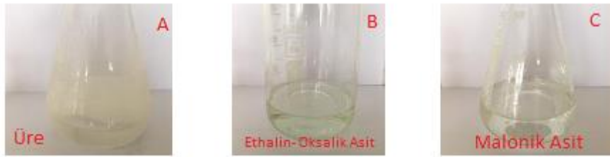
Şekil 19. Üre, Ethalin-oksalik asit ve malonik asit iyonik sıvılarının fotoğrafları.
