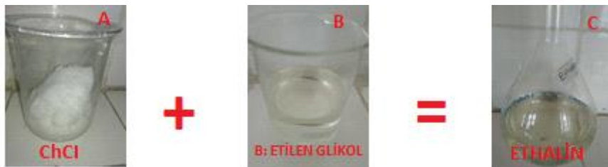
Şekil 20. Ethalin iyonik sıvısının hazırlık aşamalarının fotoğrafları.
