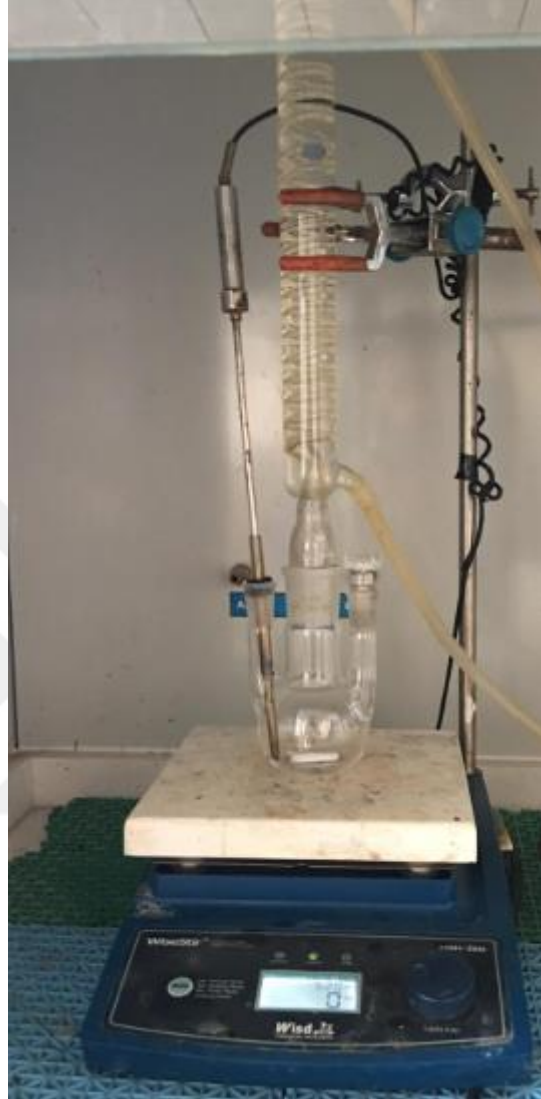
Şekil 18. Deney serisinde kullanılan karıştırmalı (Tank) liç düzeneği.
