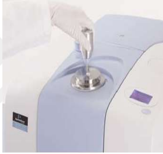
Şekil 1.10 ATR kristali üzerine numunelerin yerleştirme ve basınçlandırma işlemi.
