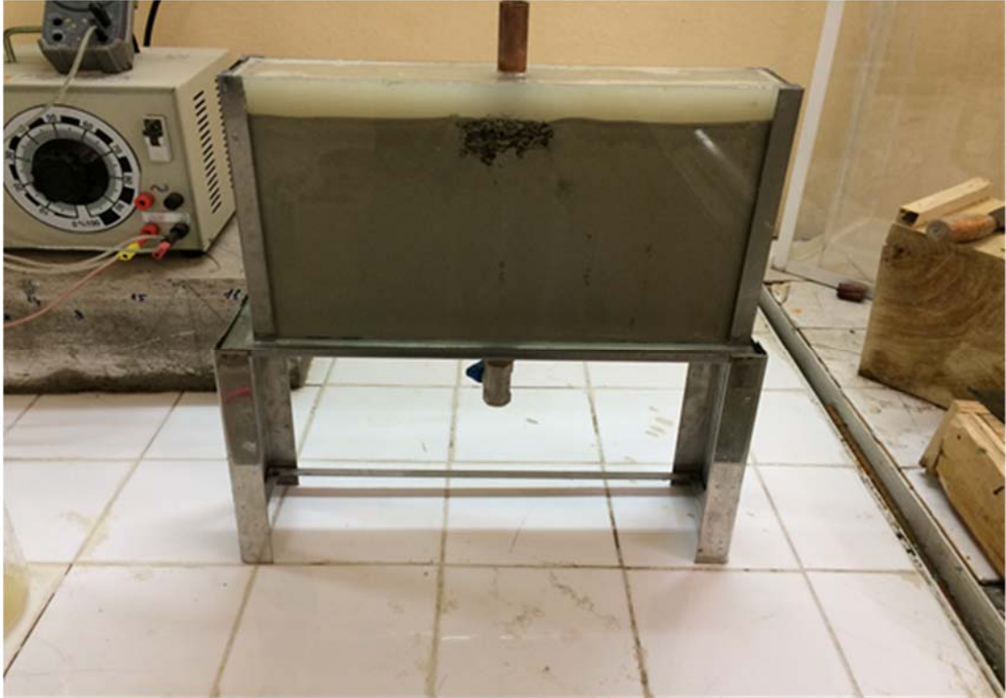
Şekil 3.15 Elektro-osmoz deneyinde gıdya malzemesinin suya doymun hale getirilmesi.
