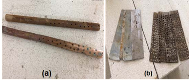
Şekil 3.12 Elektro-osmoz deneyi için kullanılan elektrotlar. (a) Bakır katod borusu, (b) düz ve delikli anod levhalar.
