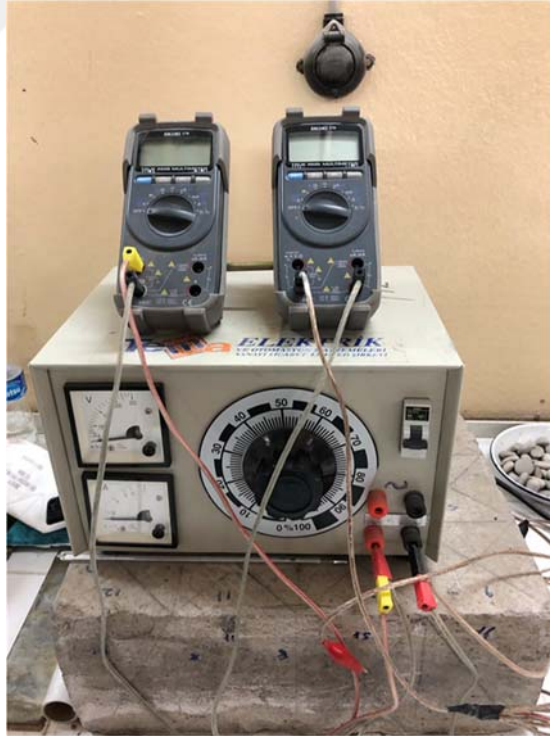
Şekil 3.14 Elektro-osmoz deneyinde kullanılan Güç kaynağı ve dijital mültimetre ve çoklu kablolar.
