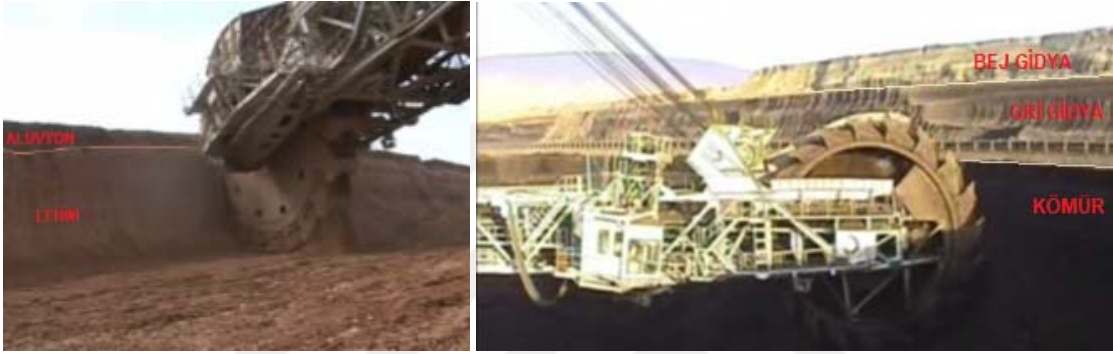
Şekil 3.6 Kışlaköy işletmesi bager ile kazı ve alüvyon, lehim, bej gıdya, gri gıdya ve kömür damarları (Resimler EÜAŞ tanıtım filminden kırılmıştır).
