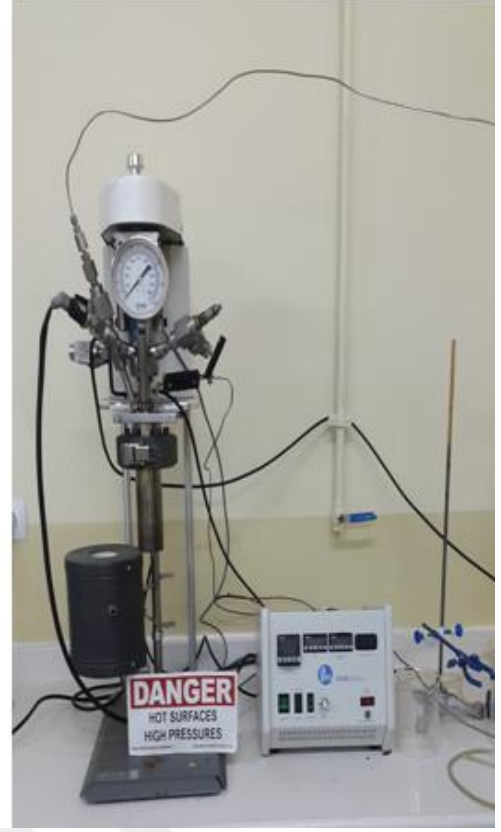
Şekil 3.1 Formaldehitin katalitik gazlaştırılmasında kullanılan kesikli reaktör sistemi
