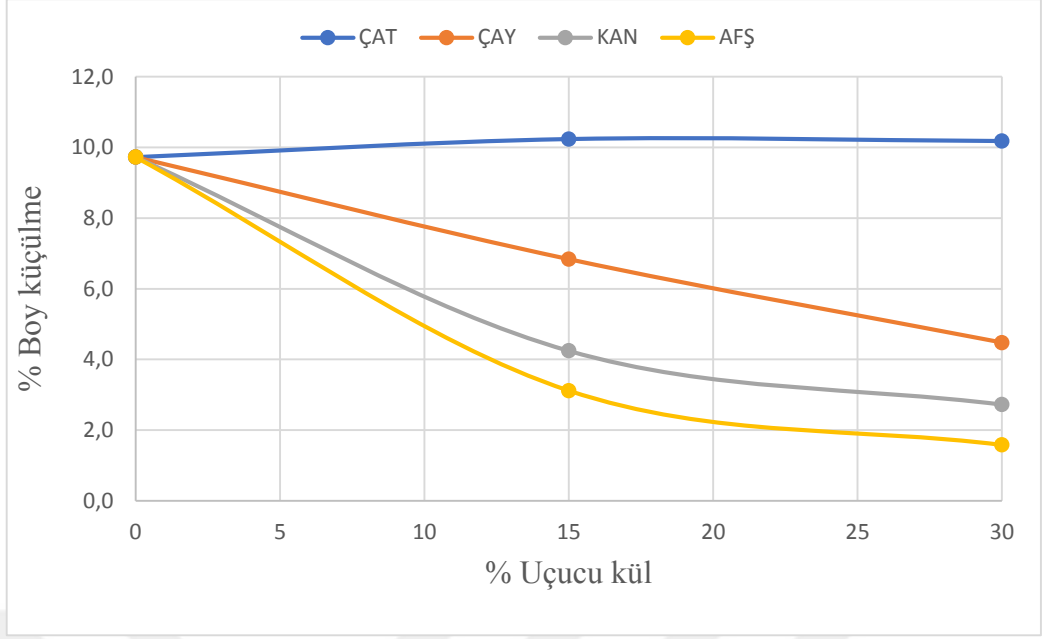
Şekil 5.15 1100 0 C de pişirilen karo numunelerinin uçucu kül- boyca küçülme grafiği
