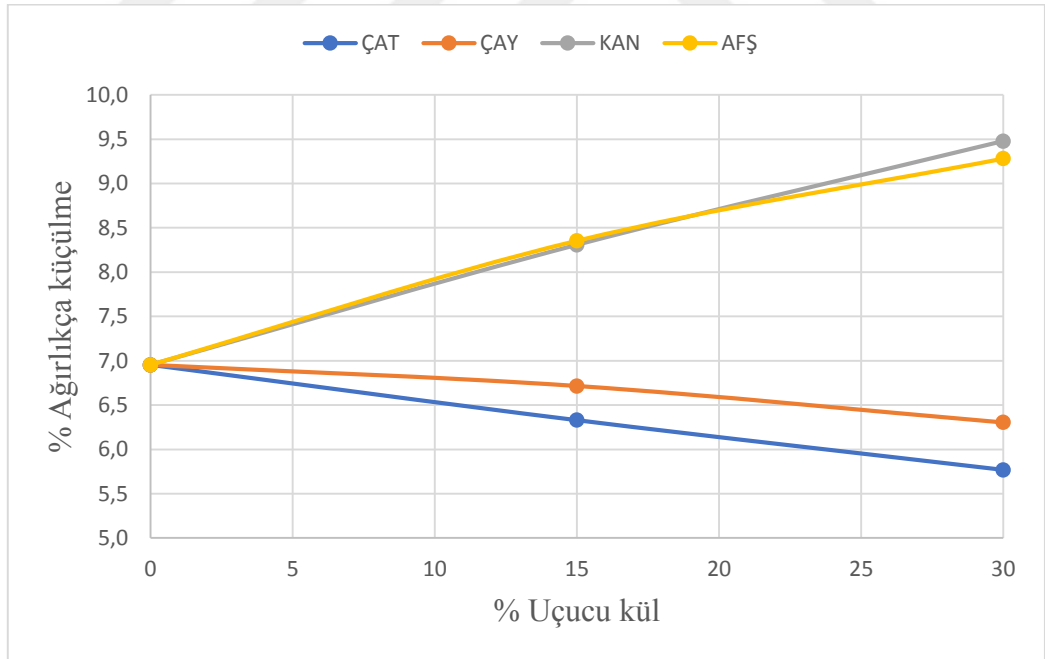
Şekil 5.24 1150 0 C de pişirilen porselen numunelerinin uçucu kül- ağırlıkça küçülme grafiği
