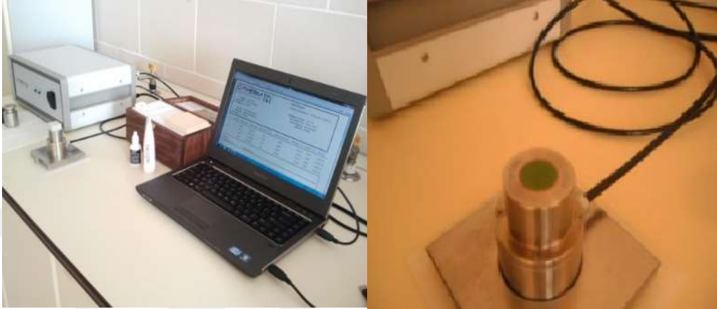
Şekil 4.37 Isıl iletkenlik katsayısı belirleme cihazı (C-THERM / TCi Thermal Conductivity)
