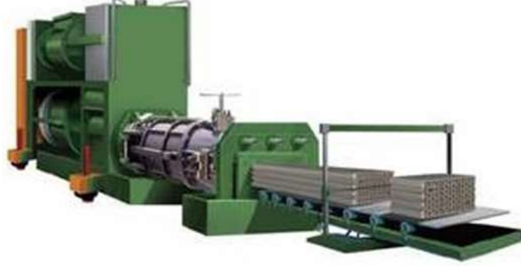
Şekil 3.10 Ekstrüzyonda tuğla üretimi ve kesilmesi
