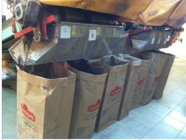
Şekil 2.2.5 Çay Fabrikası Tasnif Ünitesi
