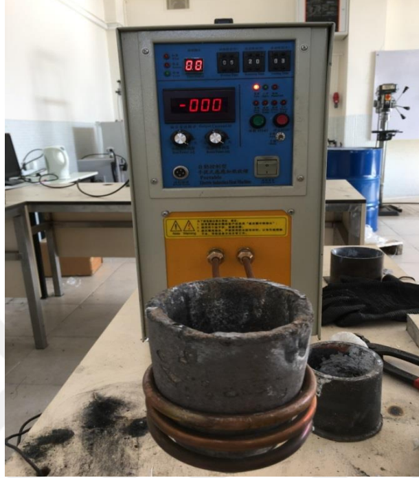
Őekil 3.1 15kW kapasiteli indksiyon ergitme ocaęı
