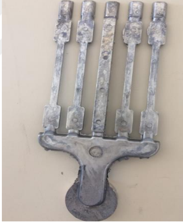
Şekil 3.3 Çekme numuneleri ve metalografik inceleme için 1 adet kare kesitli çubuk
