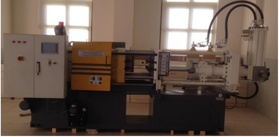
Şekil 3.2 100 ton kapasiteli soğuk kamaralı döküm cihazı
