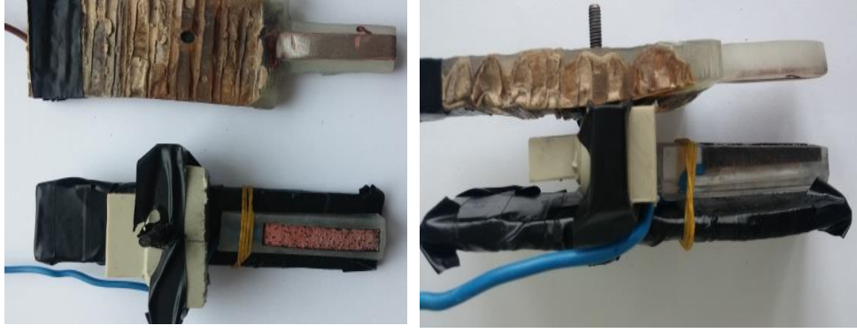
(a) Anot ve katotun deney için sabitleme şekli
