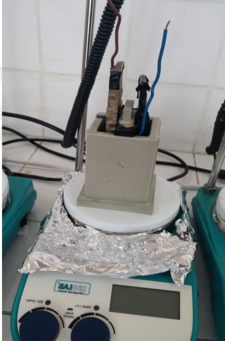
(b) Anot ve katotun hücreye yerleştirme şekli Şekil 7.2 Deneysel çalışmaların yapılışı
