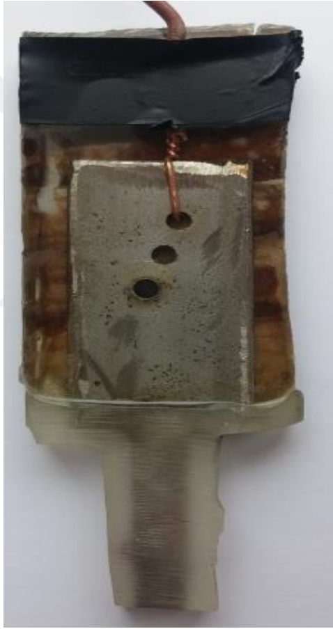
(c) katot olarak kullanılan 316L paslanmaz çelik arka yüzey
