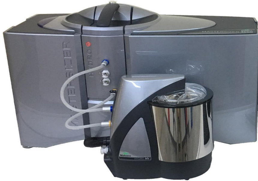
Şekil 7.6 Mastersizer 3000 lazer difraksiyonu partikül boyut analiz cihazı
