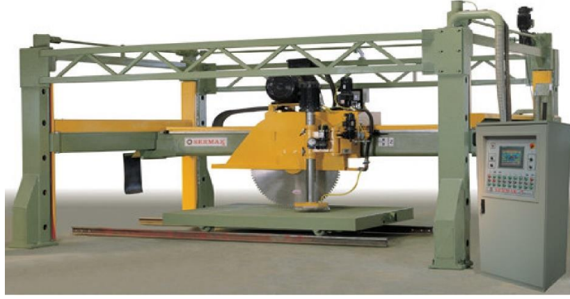
Şekil 2.3 Çift ayaklı dairesel testereli blok kesim makinesi
