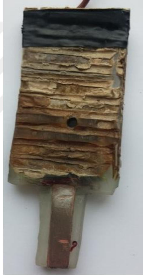
(d) ön yüzey katot olarak kullanılan 316L paslanmaz
