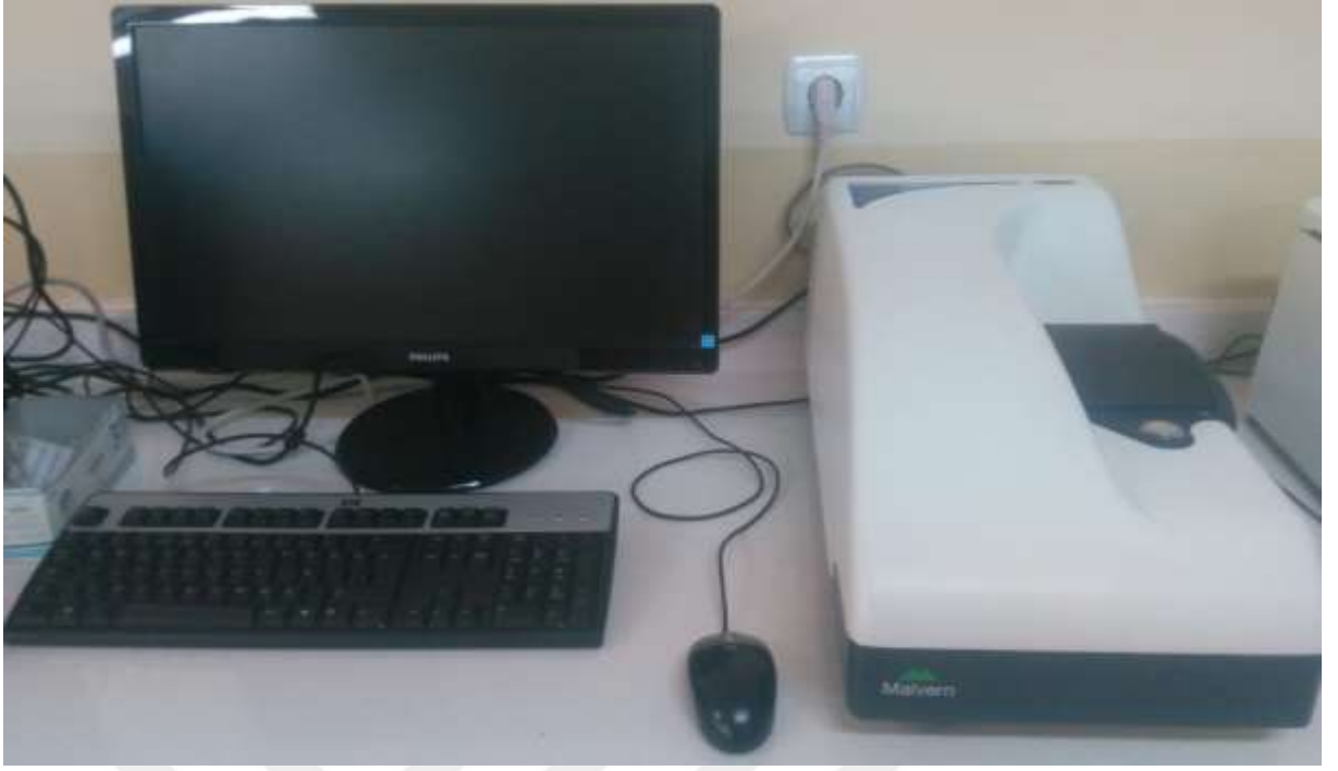
Şekil 7.6. Nanoakışkanların kararlılık testlerinin incelenmesinde kullanılan Malvern ZetasizerNano Z.
