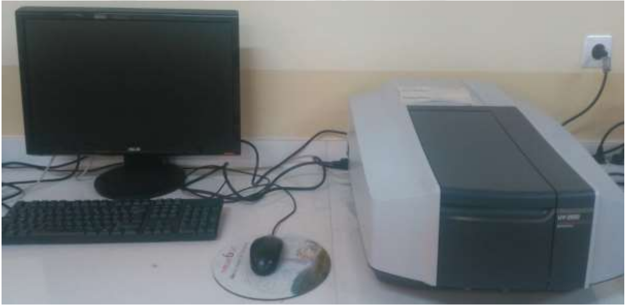
Şekil 7.7 Nanoakışkanların kararlılık testlerinin incelenmesinde kullanılan Shimadzu Marka spektrofotometre
