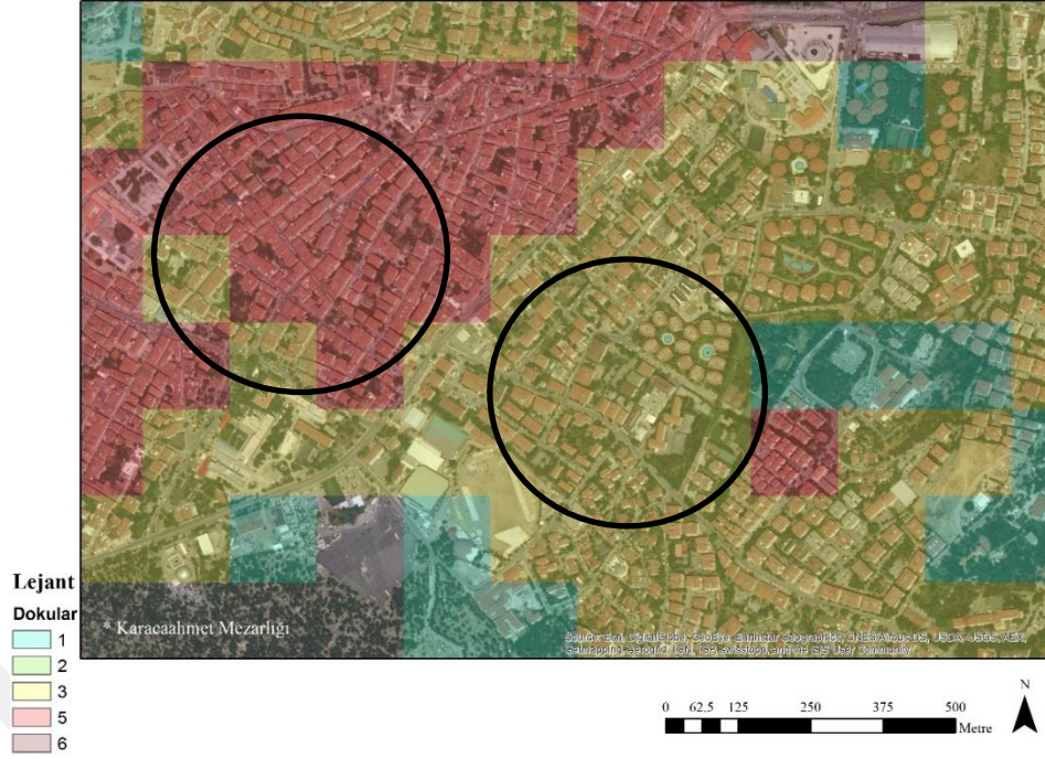
Şekil 2.14 En yüksek doğruluğa sahip genelleştirme görüntüsü (Üsküdar)(Landsat-8) Şekil 2.15'te görülen Esenler İlçesi'nin YTÜ kampüsünün sağ tarafında bulunan Bayrampaşa Sanayi Sitesi'ne bakıldığında, sanayi dokusuyla 5 numaralı yoğun konut dokusu karışmış, genelleştirme işlemi ile bu karışma giderilmiştir (Şekil 2.16).
