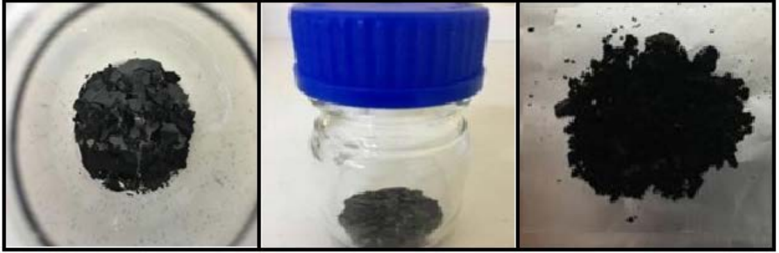
Şekil 7. İyileştirilmiş Hummers Metodu ile Sentezlenen Grafen Oksit Nanoparçacıkların Mikrodalga Yöntemi ile İndirgenmesinde İzlenen Yöntem
