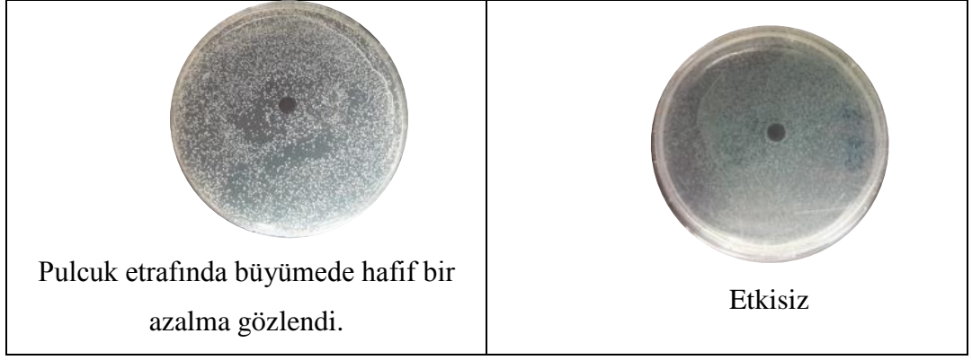
Şekil 48. Grafen oksit (%0,1-%0,3-%0,5)-Etil alkol ile kaplanmış silikon tabanlı malzemenin Staphylococcus aureus ATCC 25923 ve Pseudomonas aeruginosa ATCC 19142'ye karşı antimikrobiyal aktivitesi
