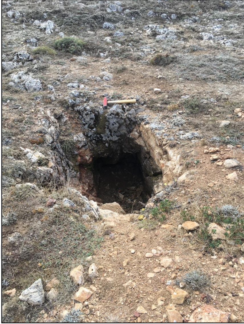
Şekil 3.11. D-1 damarı üzerinde açılmış bir nefeslik.
