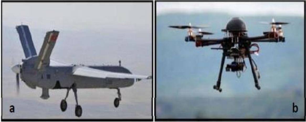
Şekil 2.6 a. Sabit kanatlı İHA b. Döner kanatlı İHA (Erdoğan, 2016).
