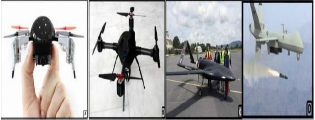
Şekil 2.7 a. Micro (Mini) insansız hava aracı, b. Küçük insansız hava aracı, c. Taktik insansız hava aracı, d. Operatif insansız hava aracı (Erdoğan, 2016).
