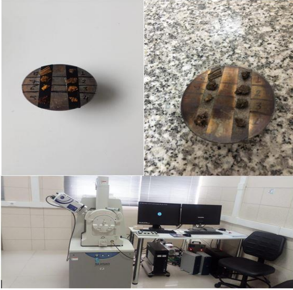
Şekil 5.1 Altın nanopartikül ile kaplanmadan önceki ve sonraki organik numune görüntüsü ile SEM cihazı
