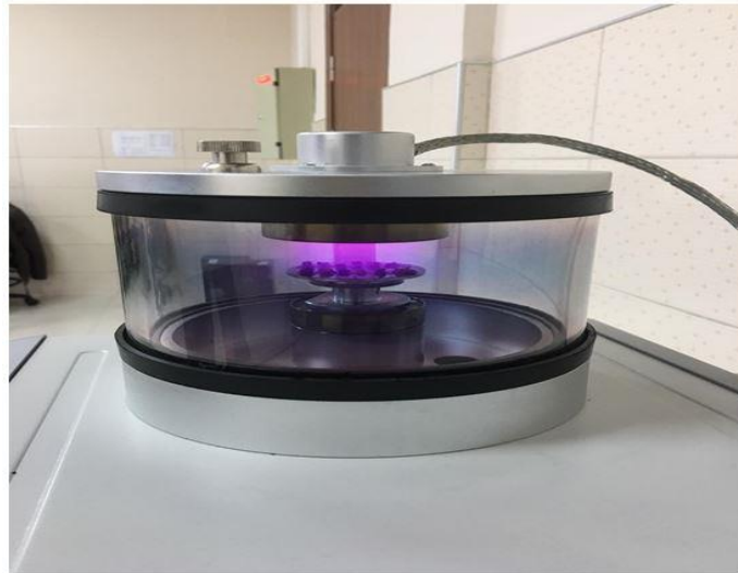
Şekil 5.2 Organik numunelerin altın nanoparçacıklarla kaplama görüntüsü
