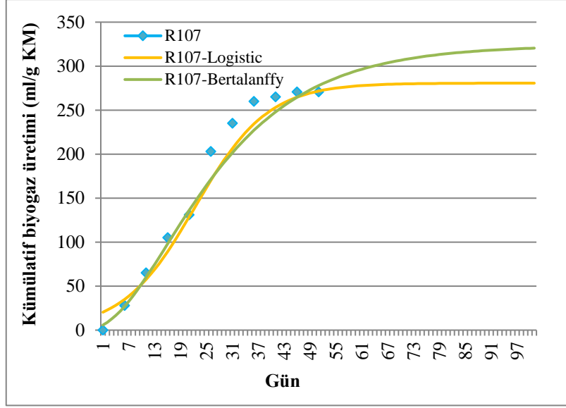
Şekil 7.19 R 107 reaktörü için Bertalanffy ve Logistic eğrilerinin gerçek değerler ile karşılaştırılması
