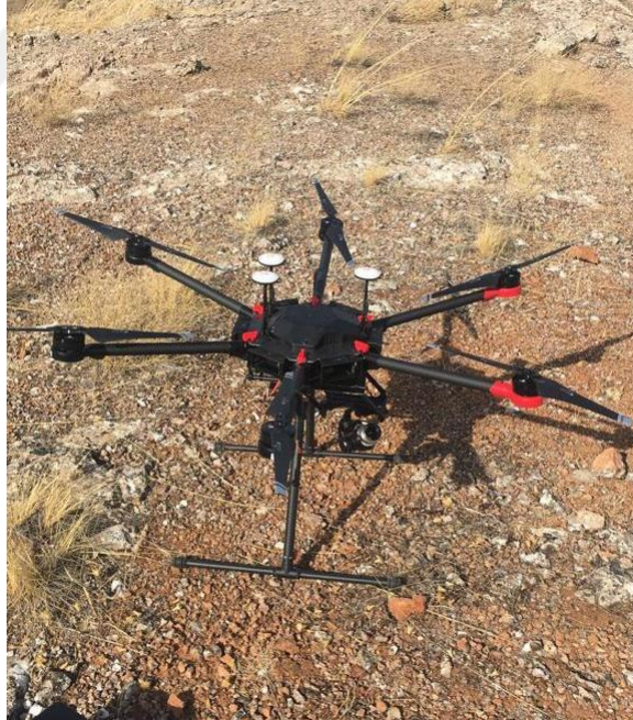
Şekil 5.5 DJI Zenmuse X5 kamera ile DJI Matrice 600 Pro drone.
