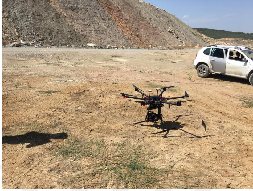
Şekil 5.6 Sony A7R II kamera ve DJI Ronin-M dengeleme halkası ile DJI Matrice 600 Pro drone.
