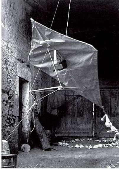
Şekil 2.2 A. Batut’un orta kısma kamera monte edilen uçurtması [23].
