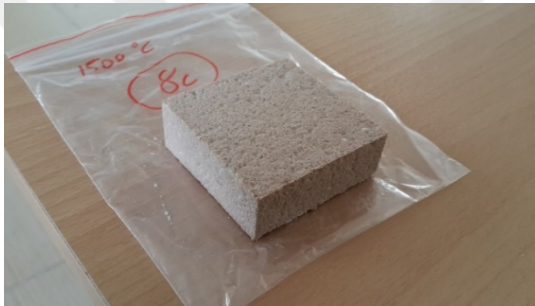
S-8 (%50 -100 µm Şamot-%50 Manyezit)
