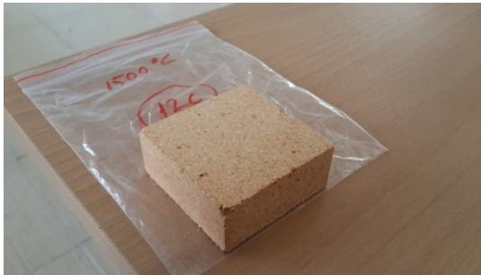
S-12 (%50-25-25 Şamot (-100 µm,0,1-1,1-3 mm))
