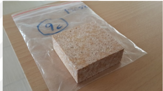
S-9 (%40 -100 µm Şamot-%60 Manyezit)
