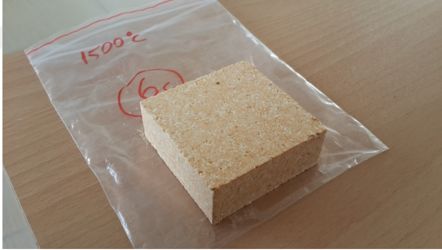
Şekil 5.5 S-6 kodlu (%40 -100 µm Şamot, %60 Müllit-1500 °C) Numune
