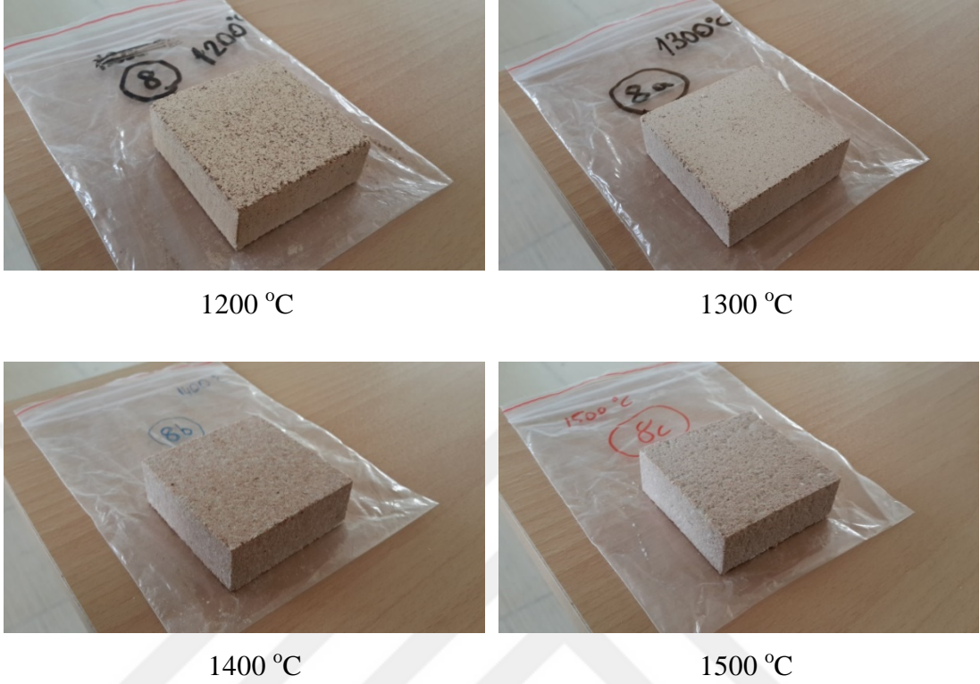
Şekil 5.4 S-8 kodlu (%50 -100 µm Şamot, %50 Manyezit) sinterlenmiş numuneler
