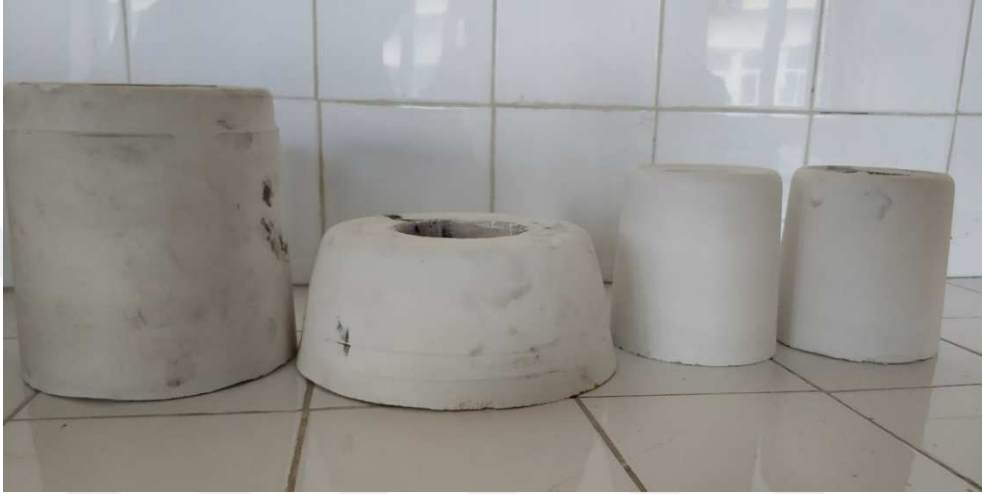
Şekil 5.5 Seramik döküm için hazırlanan alçı kalıplar
