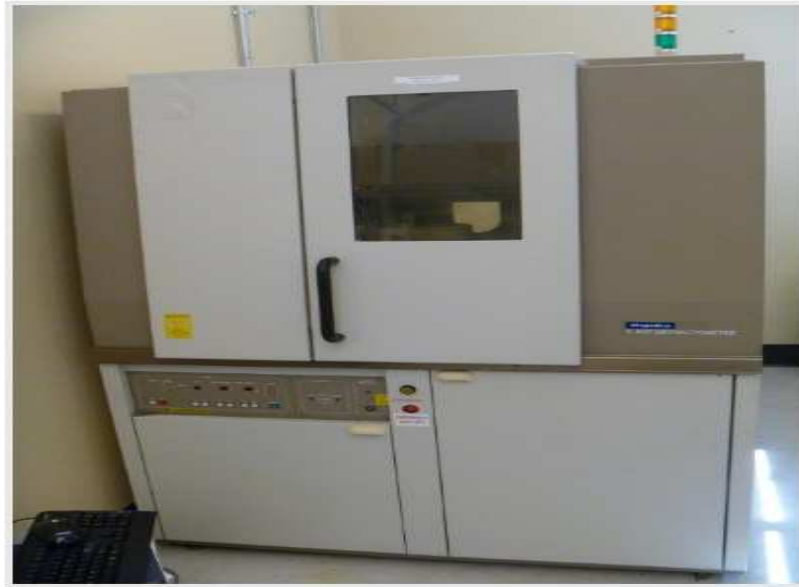
Şekil 5.22 Analizlerde kullanılan RIGAKU D/MAX/2200/PC marka XRD cihazı
