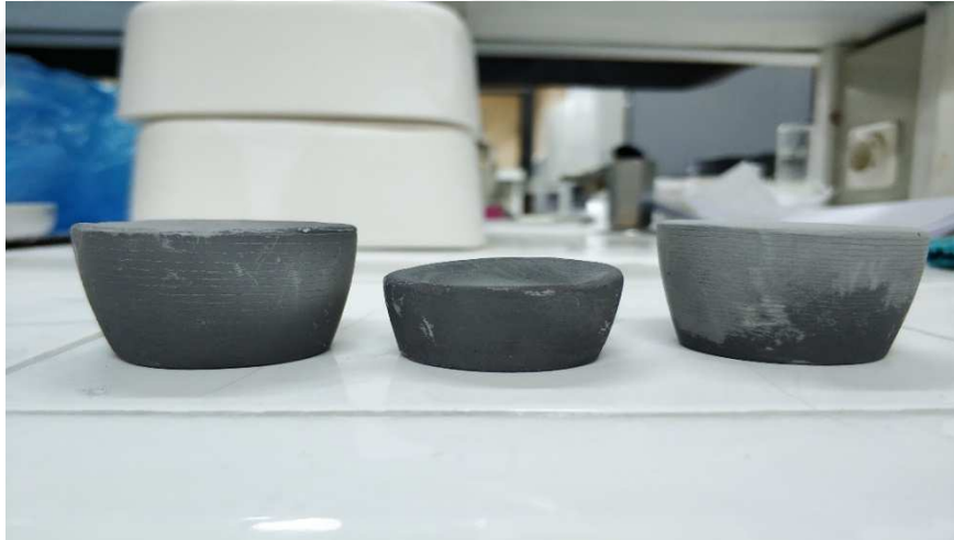
Şekil 6.30 Sinterlenen SiC-AYC seramik potaların görüntüsü
