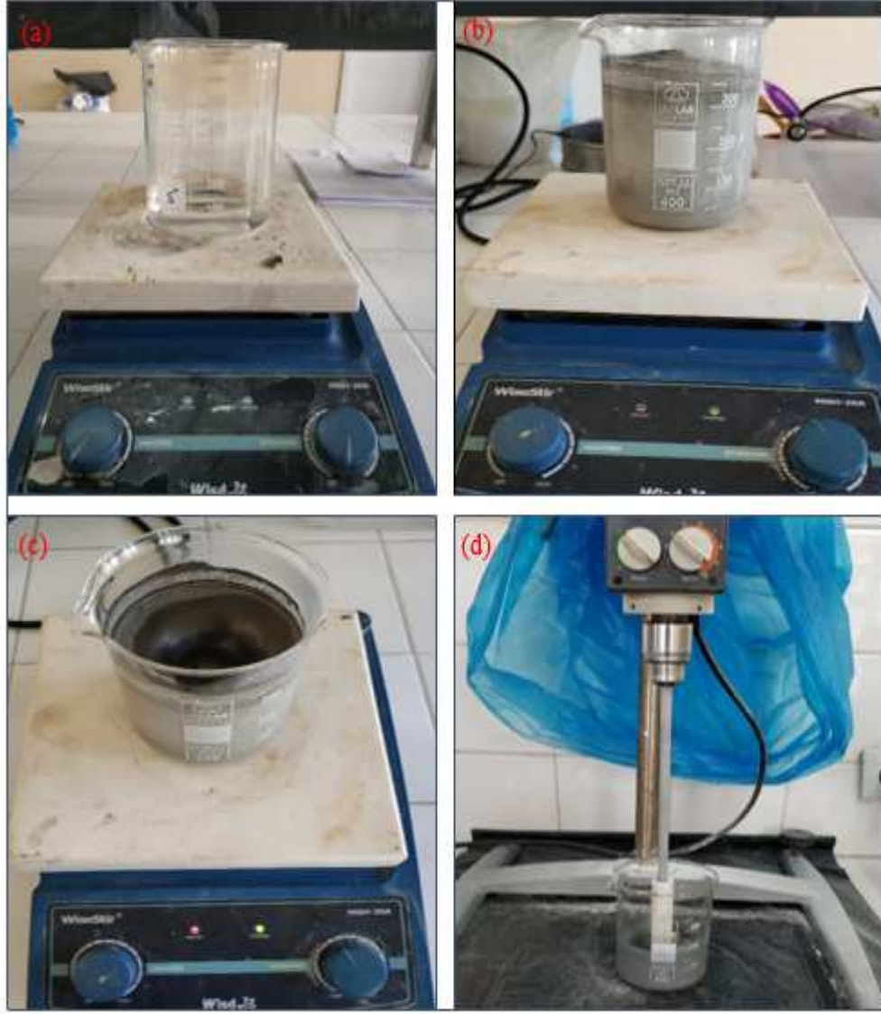
Şekil 5.6 Döküm çamurunun hazırlanması a) %0.3 derişimli CMC-Na çözeltisi b) CMC-Na çözeltisi ve SiC karışımı c) Kimyasalların eklentisinden sonraki görünümü d) Mekanik karıştırıcı ile döküm çamurunun oluşturulması
