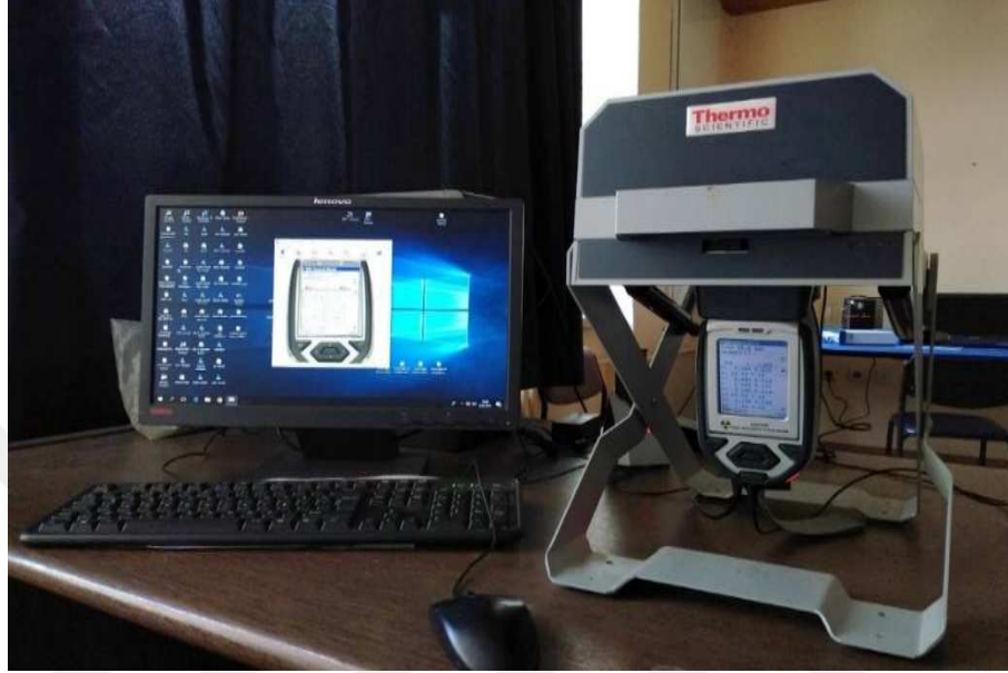
Şekil 5.21 Analizlerde kullanılan Thermo Scientific-niton XL3t marka XRF cihazı
