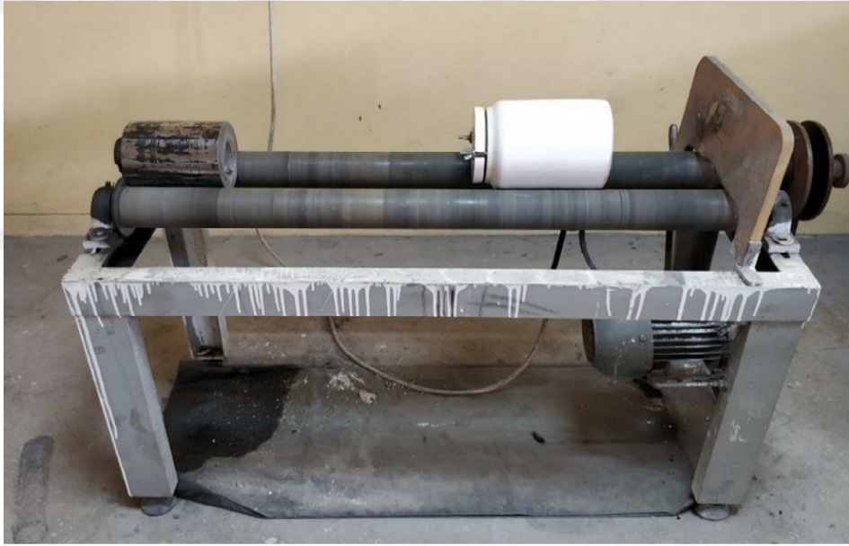
Şekil 5.24 Öğütme İşlemlerinde kullanılan bilyalı değirmen cihazı
