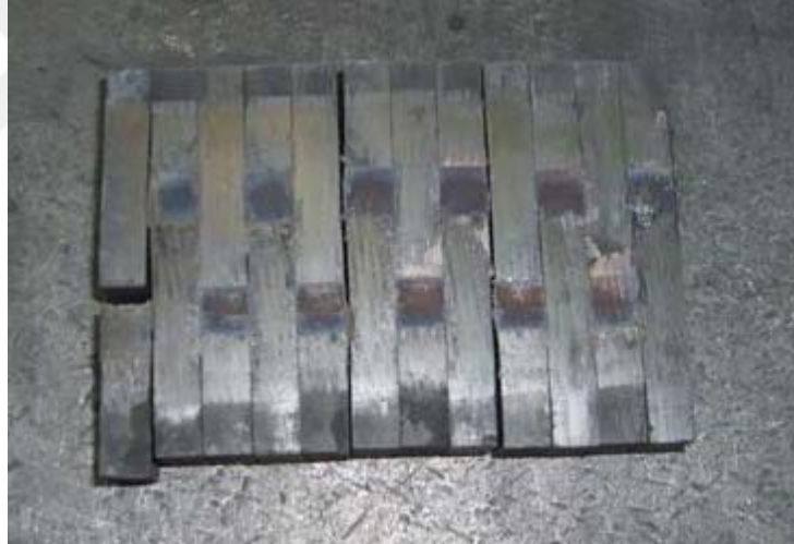
Şekil 4.9. Sıcak Pres Sinterlemesi İle Üretilen Soketlerin Sinterlendikten Sonra Nihai Görünümü
