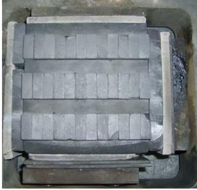
Şekil 4.8. Sıcak Pres Sinterlemesi İle Üretilen Soketlerin Sinterlendikten Sonra Grafit Kalıp İçerisinde Görünümü
