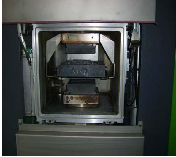
Şekil 4.4. Kalıp İçerisinde Sinterlenmiş Soketlerin Sıcak Pres İçerisindeki Görünümü
