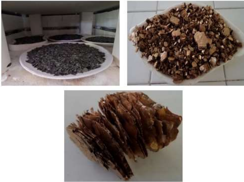
Şekil 5.2 Ham, kalsine edilmiş ve genişmiş vermikülitte ait fotoğraflar.
