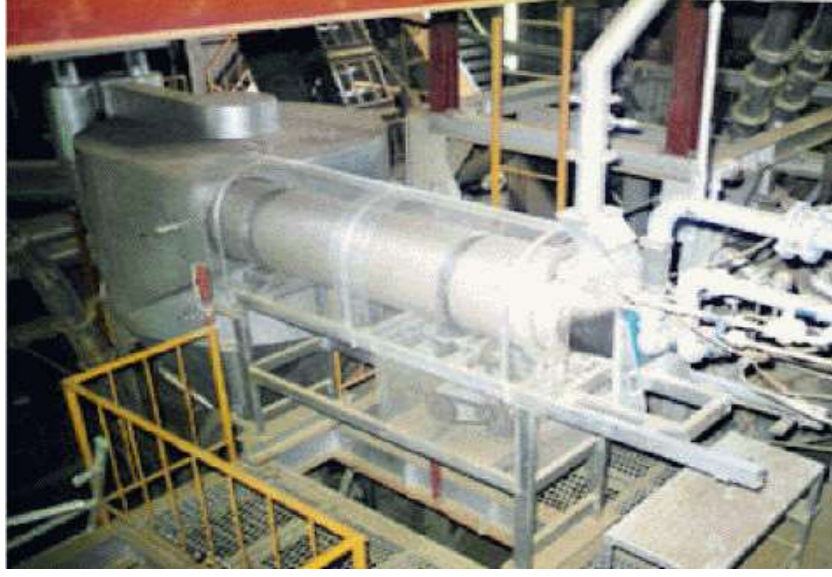
Şekil 2.8 Genleştirilmiş vermikülit üretiminde kullanılan döner fırın.
