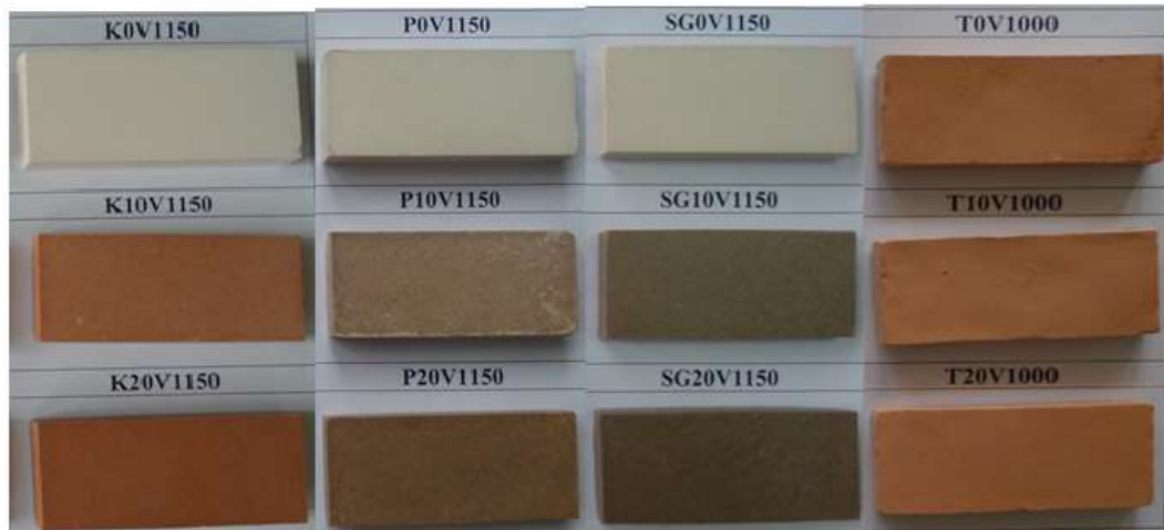
Şekil 6.26 1150 °C de pişmiş katkısız, %10 ve %20 vermikülit katkılı karo, porselen vitrikiye ve tuğla numunelerinde renkler.
