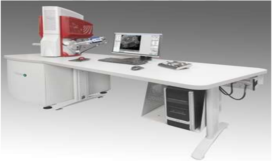
Şekil 5.22 Mira3XMU FE-SEM (Tescan®, Çek Cumhuriyeti) marka taramalı elektron mikroskobu
