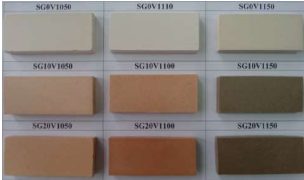
Şekil 6.24 Pişmiş vitrifiye numunelerde renkler.
