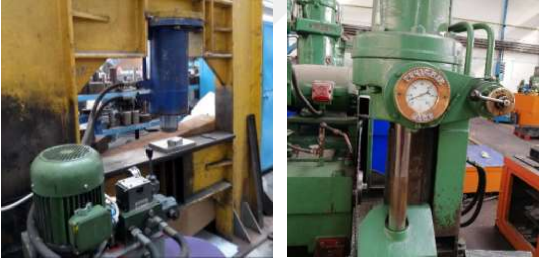
Şekil 5.10 Tozların şekillendirilmesinde kullanılan hidrolik pres.
