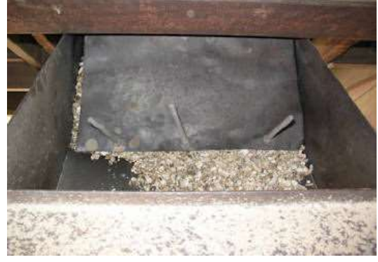
Şekil 2.6 Düşey fırında vermikülit'in genişletilmesi.
