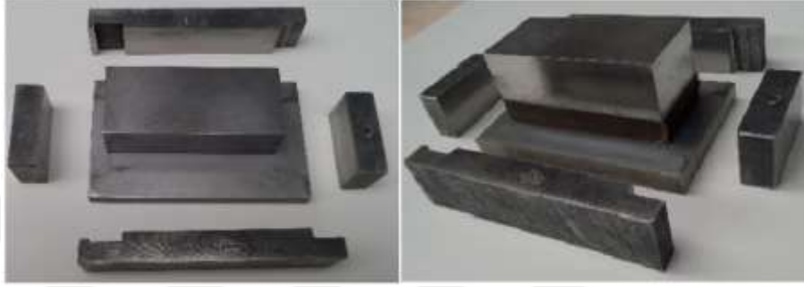
Şekil 5.9 Pres ile şekillendirmede kullanılan sertleştirilmiş çelik kalıp.
