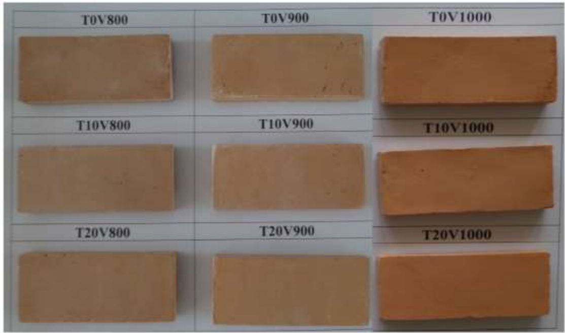
Şekil 6.25 Pişmiş tuğla numunelerde renkler.
