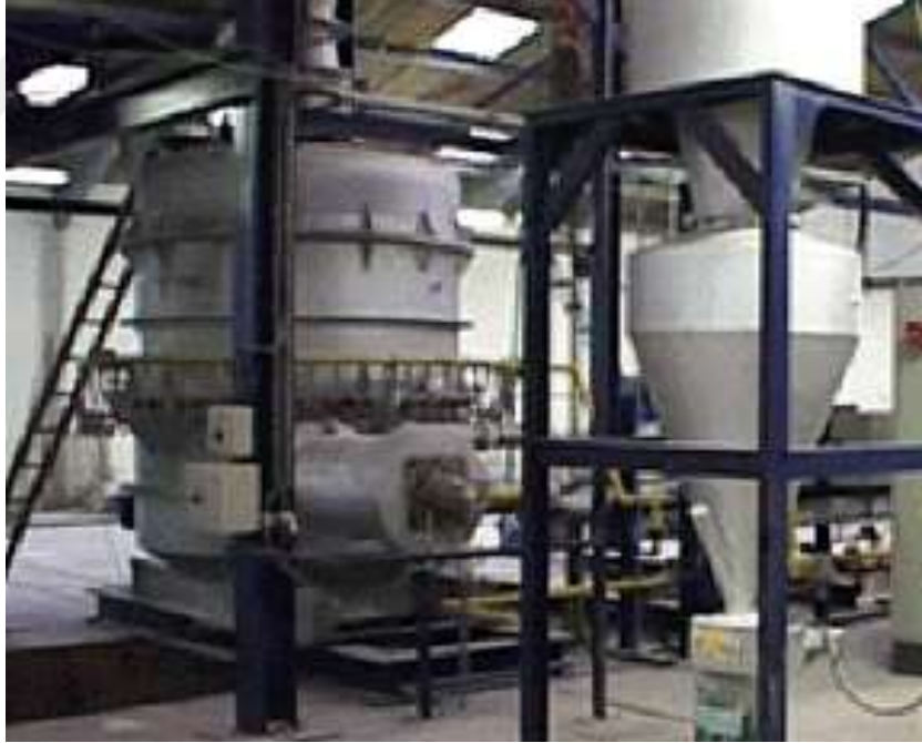
Şekil 2.9 Genleştirilmiş vermikülit üretiminde kullanılan toroidal fırın.
