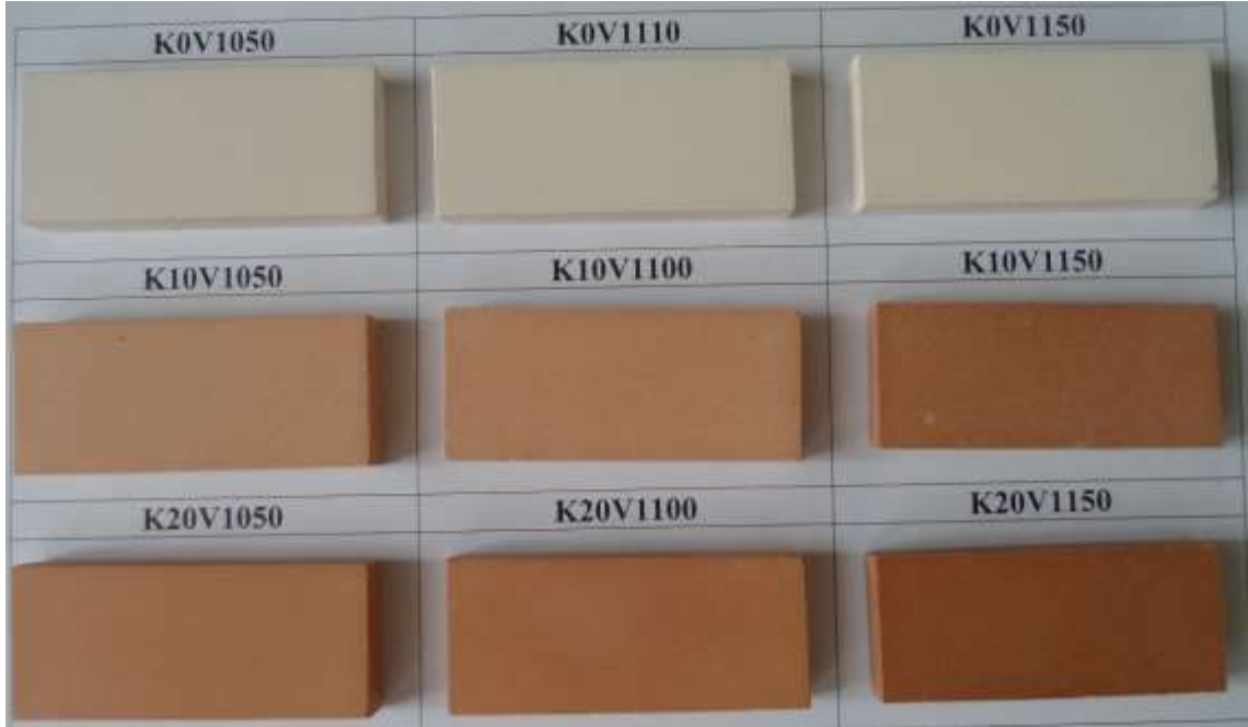
Şekil 6.22 Pişmiş karo numunelerde renkler.
