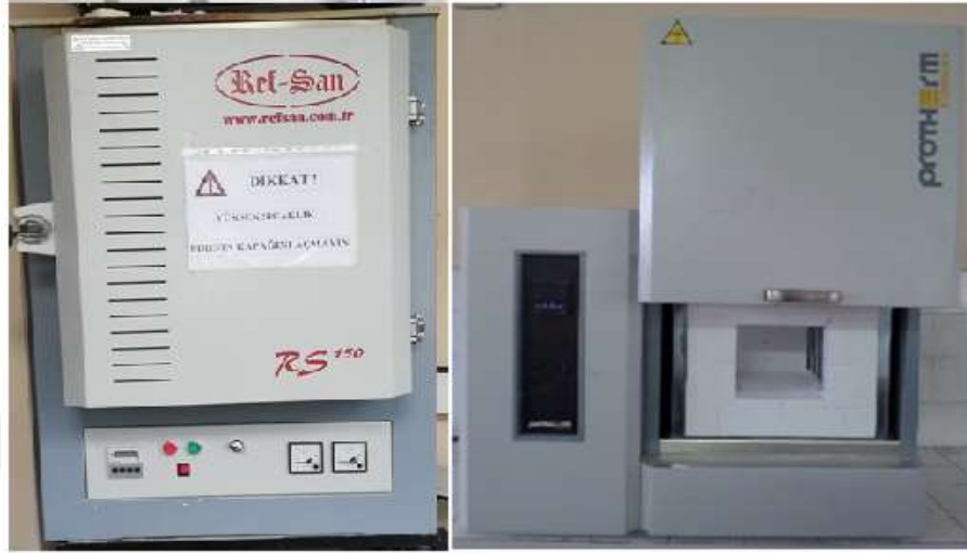
Şekil 5.11 Elektrik ısıtmalı yüksek sıcaklık fırınları.
