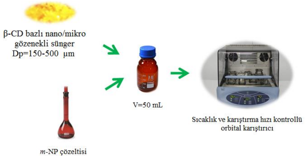
Şekil 3.2 \beta -CD bazlı nano/mikro gözenekli süngerlere m -NP'ün adsorpsiyon süreci.
