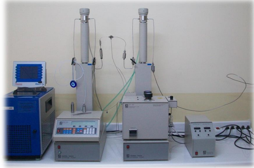
Şekil 3.3 Süperkritik akışkan rejenerasyon sistemi.
