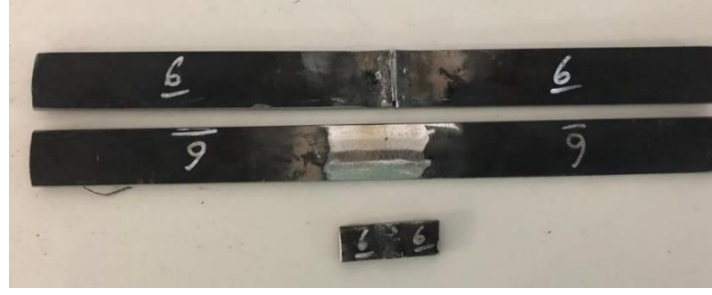
Şekil 3.28 Testler Öncesi Oksi-Gaz Kaynak Yöntemi ile Birleştirilmiş X42N Borunun Numune Resimleri (a) Parça kodu: 1 (b) Parça kodu: 6
