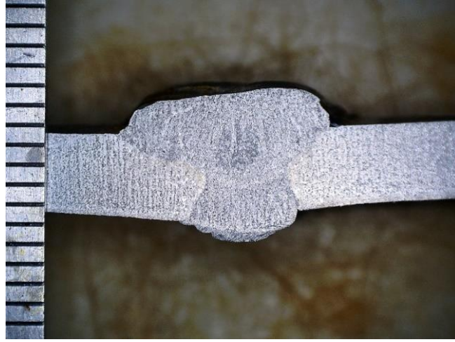
Şekil 4.27 Numunenin Makro Yapısı (Parça Kodu: 8)
