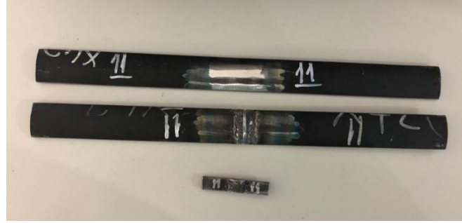
Şekil 3.23 Testler Öncesi TIG Kaynak Yöntemi ile Birleştirilmiş X42N Borunun Numune Resimleri (Parça kodu: 11)
