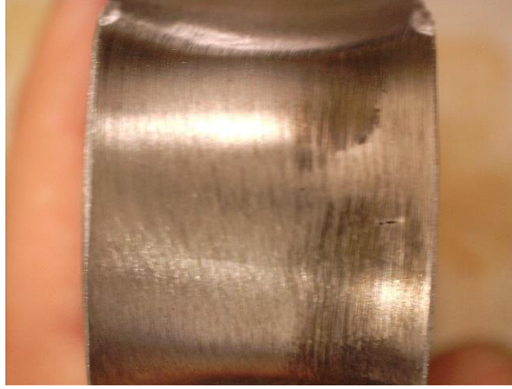
Şekil 4.29 Kök Eğme Testi Sonrası Numune Görünümü (Parça Kodu: 9)
