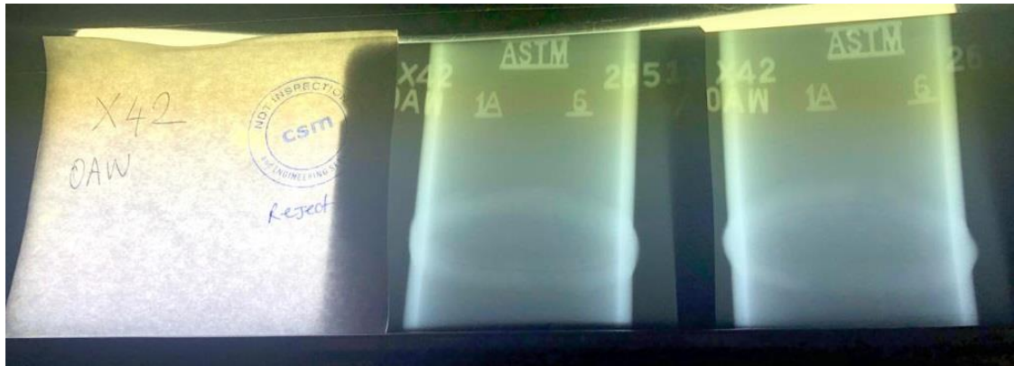
Şekil 4.7 Oksi – Gaz Kaynak Yöntemi ile Birleştirilmiş X42N Boru (Parça Kodu: 1)
