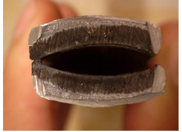
Şekil 4.46 Çentikli Kırma Testi Sonrası Numune Görünümü (Parça Kodu: 2 ve 4)
