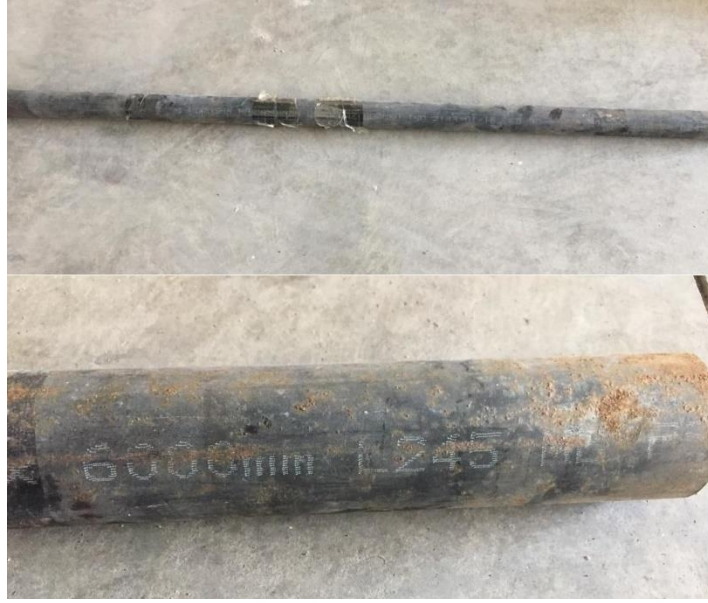
Şekil 3.4 TS EN ISO 3183 L245 Kalite B Numune Resmi
