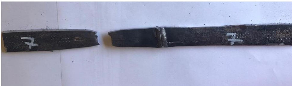
Şekil 4.34 Çentikli Kırma Testi Sonrası Numune Görünümü (Parça Kodu: 7)
