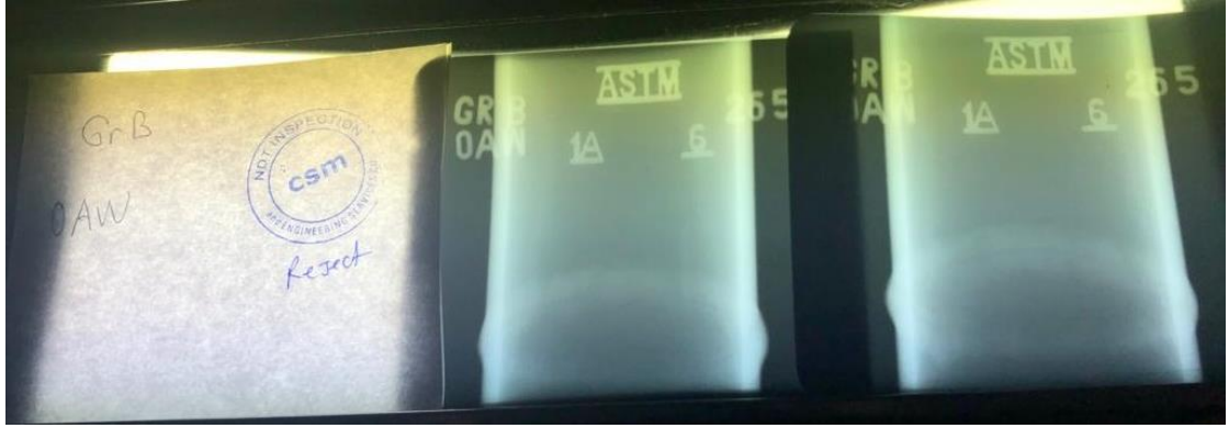
Şekil 4.11 Oksi – Gaz Kaynak Yöntemi ile Birleştirilmiş Kalite B Boru (Parça Kodu: 3)
