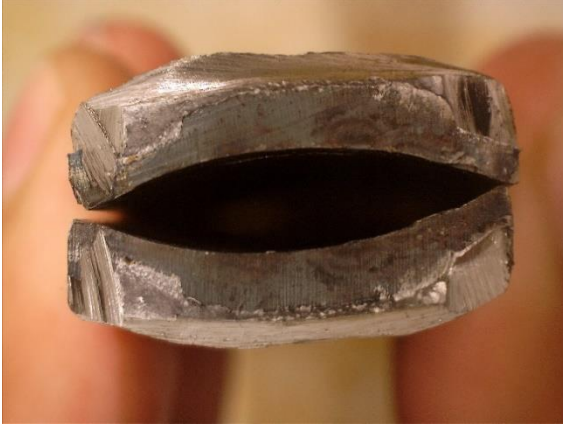
Şekil 4.46 Çentikli Kırma Testi Sonrası Numune Görünümü (Parça Kodu: 2 ve 4)
