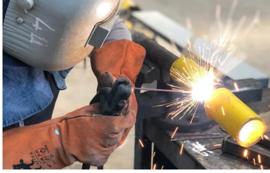
Şekil 3.13 (a) X42N (b) Kalite A (c) Kalite B Boruların Elektrik Ark Kaynak Yöntemi ile Kaynak Edilmesi
