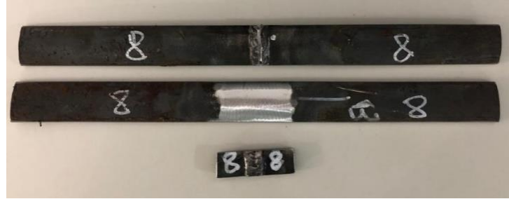
Şekil 3.26 Testler Öncesi Elektrik Ark Kaynak Yöntemi ile Birleştirilmiş Kalite B Borunun Numune Resimleri (Parça kodu: 8)
