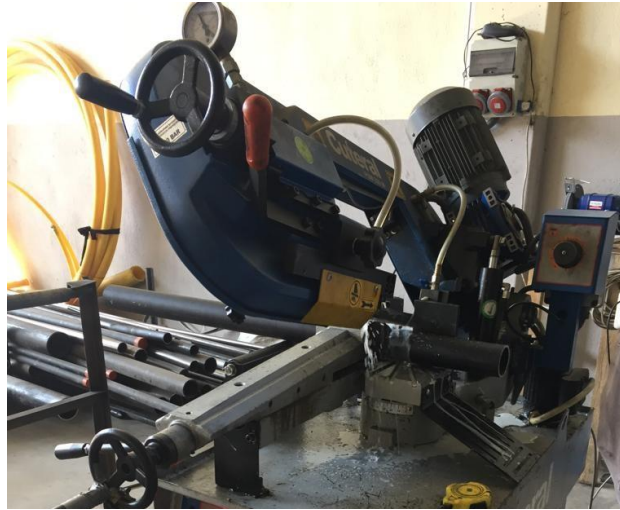
Şekil 3.5 Boruların Otomatik Testere İle Kesimi
