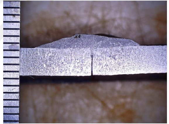
Şekil 4.47 Numunenin Makro Yapısı (Parça Kodu: 2 ve 4)
