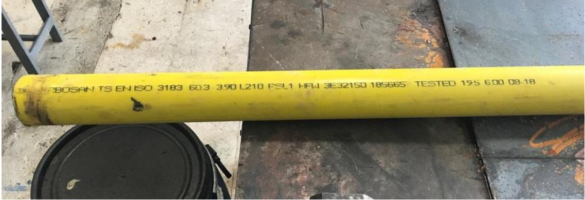
Şekil 3.3 TS EN ISO 3183 L210 Kalite A Numune Resmi
