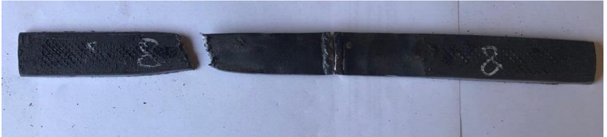
Şekil 4.26 Çentikli Kırma Testi Sonrası Numune Görünümü (Parça Kodu: 8)
