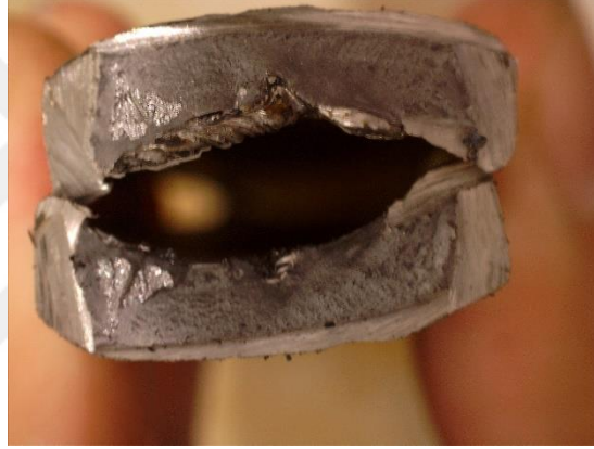
Şekil 4.30 Çentikli Kırma Testi Sonrası Numune Görünümü (Parça Kodu: 9)
