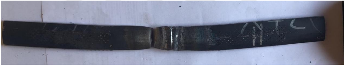
Şekil 4.18 Çentikli Kırma Testi Sonrası Numune Görünümü (Parça Kodu: 11)
