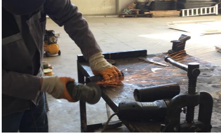
Şekil 3.6 Taşlama İşlemi ve Kaynak Ağzı Açılması
