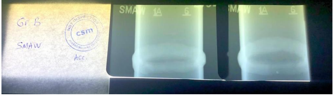
Şekil 4.5 Elektrik Ark Kaynak Yöntemi ile Birleştirilmiş Kalite B Boru (Parça Kodu: 8)
