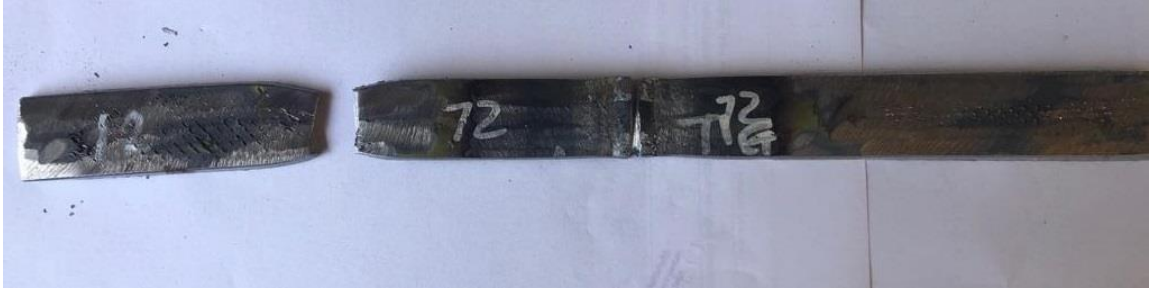
Şekil 4.22 Çentikli Kırma Testi Sonrası Numune Görünümü (Parça Kodu: 12)
