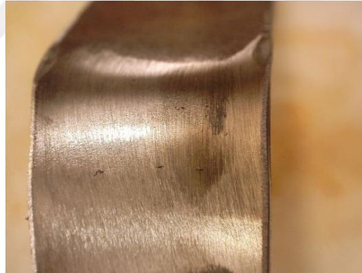
Şekil 4.33 Kök Eğme Testi Sonrası Numune Görünümü (Parça Kodu: 7)
