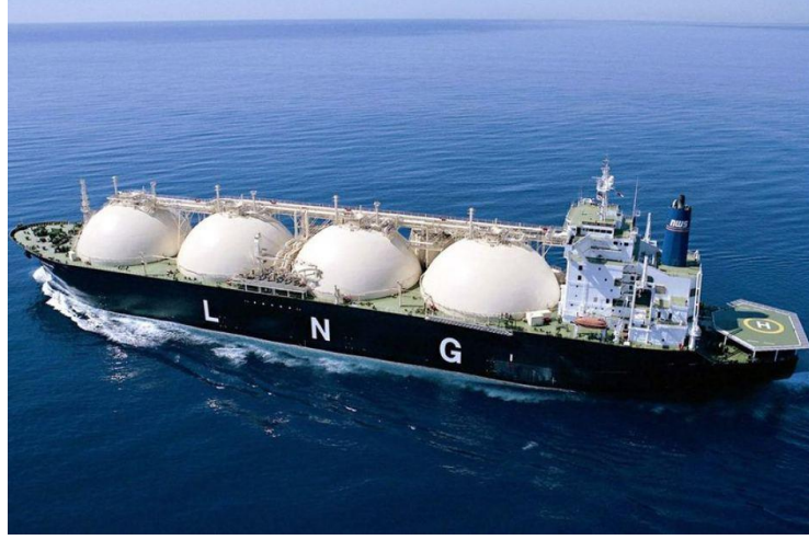
Şekil 2.4 LNG Taşımacılığında Kullanılan Yük Gemisi
