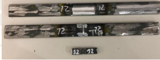
Şekil 3.24 Testler Öncesi TIG Kaynak Yöntemi ile Birleştirilmiş Kalite A Borunun Numune Resimleri (Parça kodu: 12)
