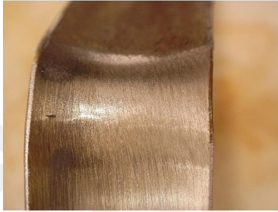
Şekil 4.25 Kök Eğme Testi Sonrası Numune Görünümü (Parça Kodu: 8)
