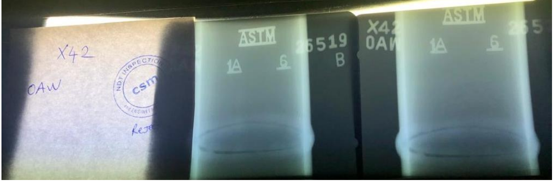
Şekil 4.8 Oksî – Gaz Kaynak Yöntemi ile Birleştirilmiş X42N Boru (Parça Kodu: 6)
