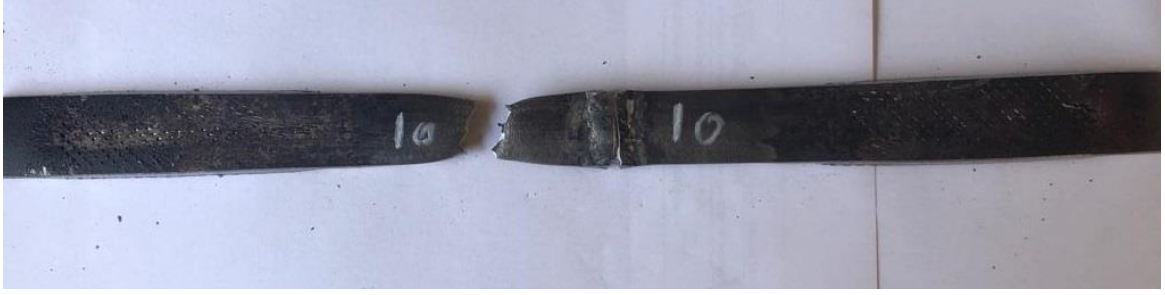
Şekil 4.14 Çentikli Kırma Testi Sonrası Numune Görünümü (Parça Kodu: 10)
