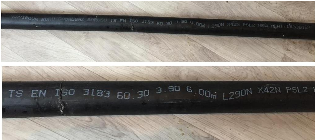
Şekil 3.2 TS EN ISO 3183 L290 X42N Numune Resmi
