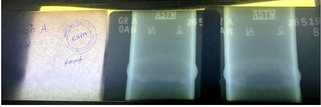
Şekil 4.10 Oksi – Gaz Kaynak Yöntemi ile Birleştirilmiş Kalite A Boru (Parça Kodu: 4)
