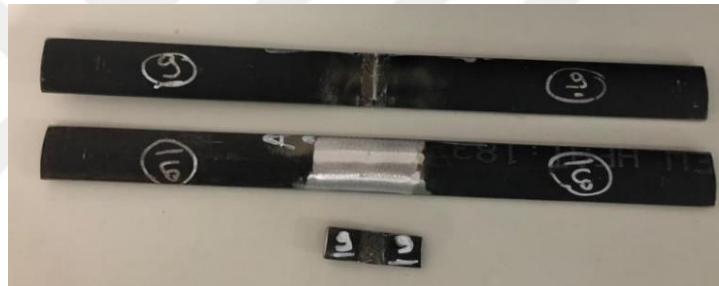
Şekil 3.27 Testler Öncesi Elektrik Ark Kaynak Yöntemi ile Birleştirilmiş X42N Borunun Numune Resimleri (Parça kodu: 9)
