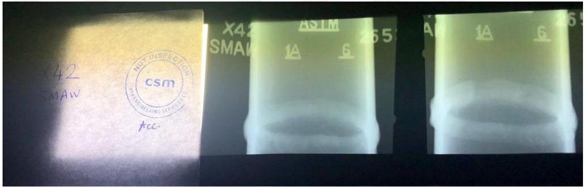
Şekil 4.6 Elektrik Ark Kaynak Yöntemi ile Birleştirilmiş X42N Boru (Parça Kodu: 9)
