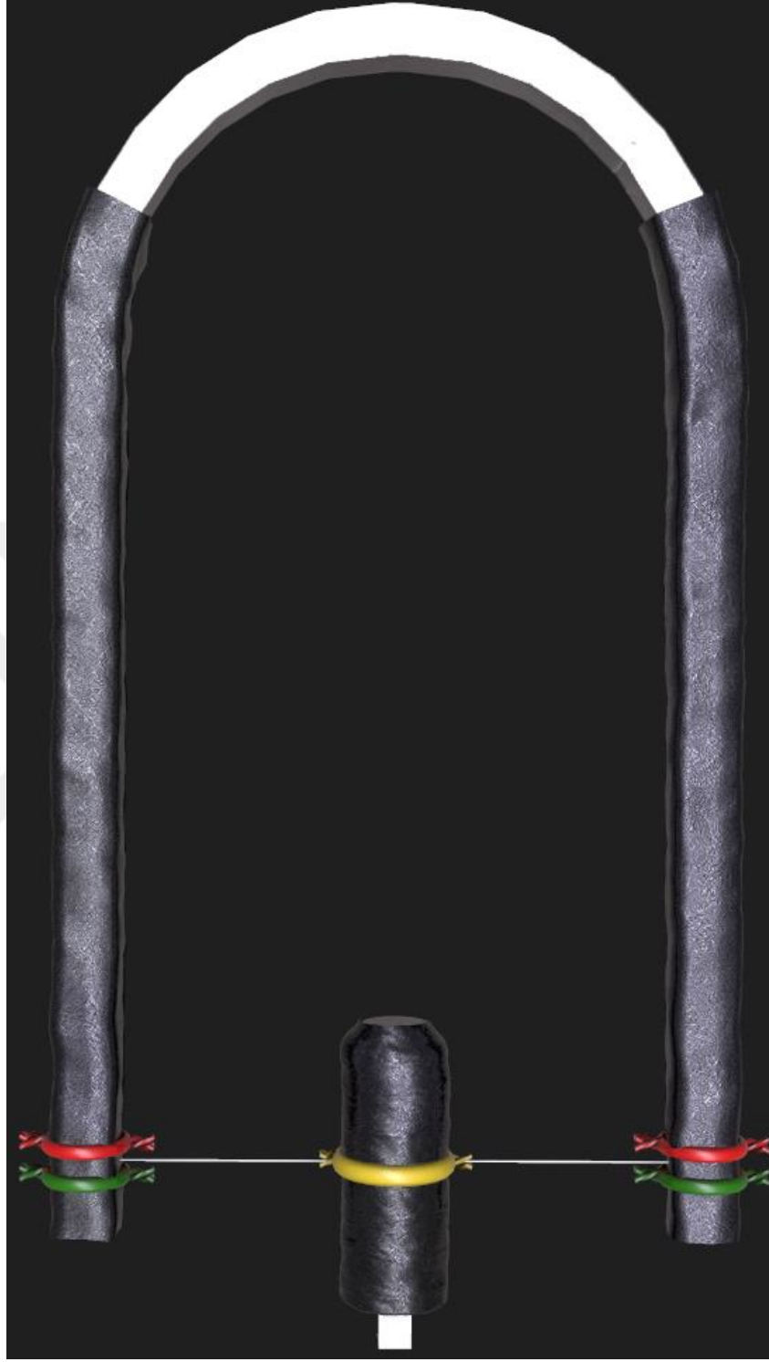
Şekil 3.2. Üretilen manyetik kaçak akı cihazının iç görünümü
