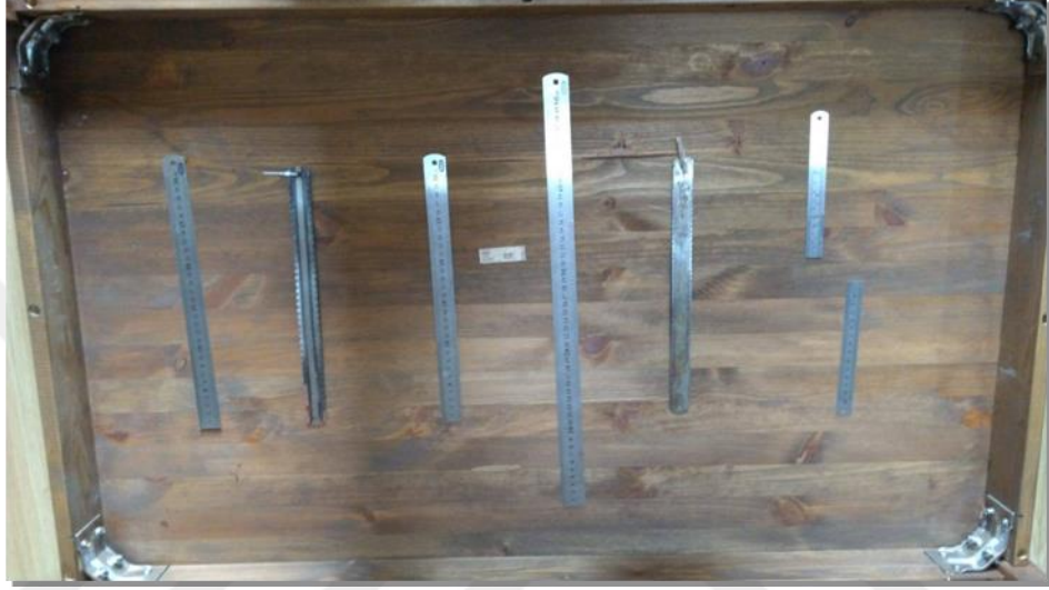
Şekil 4.1. 90 \times 60 cm boyutlu birinci test düzeneğine yerleştirilen ferromanyetik malzemelerin konumları (Altan görünüş)
