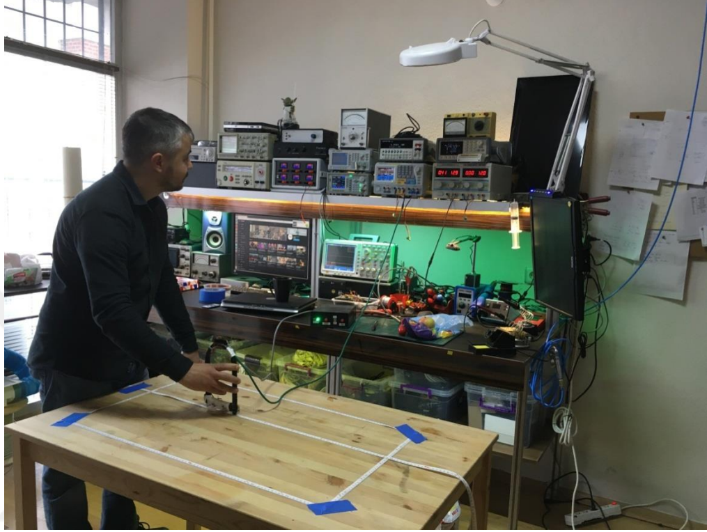
Şekil 4.7. 85 × 50 cm ikinci test düzeneğinde gerçekleştirilen MKA ölçümü
