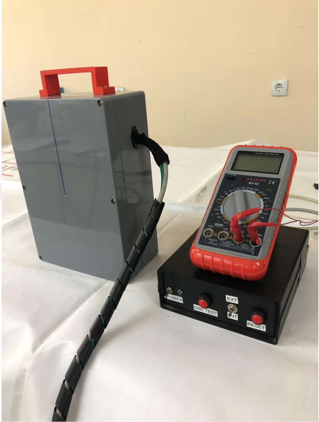
Şekil 3.2. Üretilen manyetik kaçak akı cihazının dış görünümü
