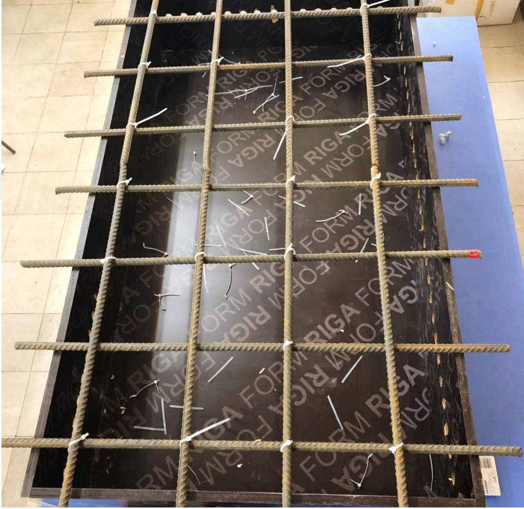
Şekil 4.16. 80 × 150 cm boyutlu birinci test düzeneğine yerleştirilen inşaat çeliklerinin konumları
