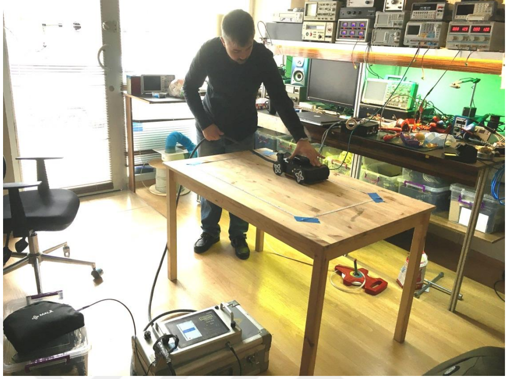
Şekil 4.8. 85 × 50 cm ikinci test düzeneğinde gerçekleştirilen GPR ölçümü
