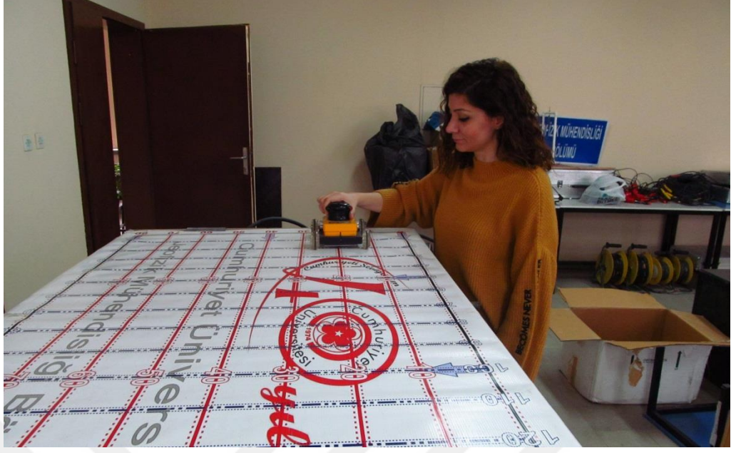
Şekil 4.13. 80 × 150 cm üçüncü test düzeneğinde gerçekleştirilen GPR ölçümü
