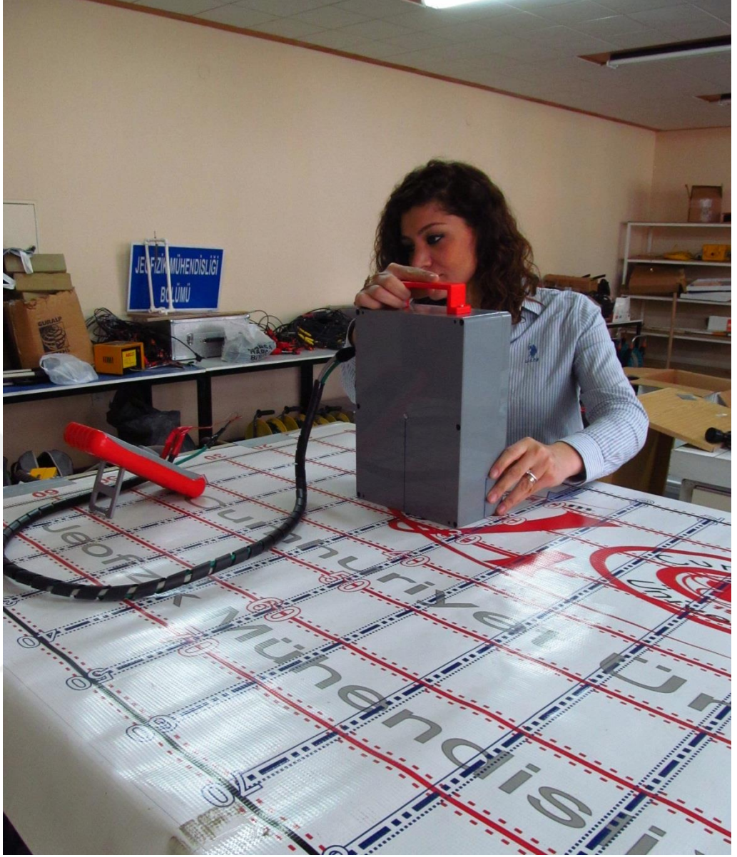
Şekil 4.12. 80 × 150 cm ikinci test düzeneğinde gerçekleştirilen MKA ölçümü
