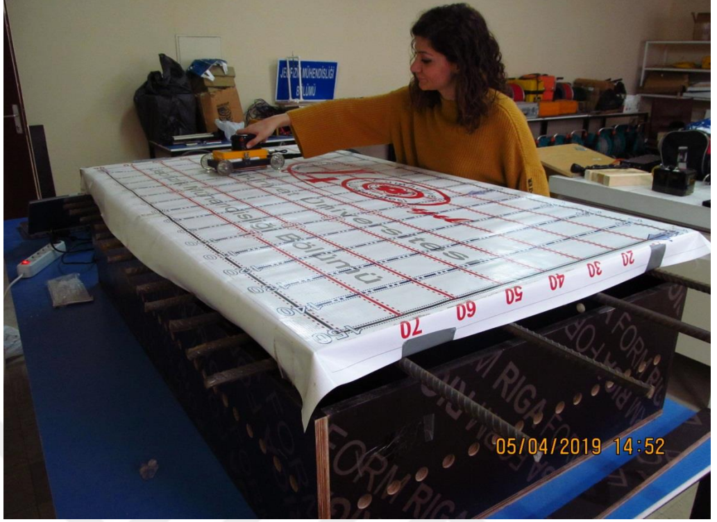
Şekil 4.18. 80 \times 150 cm dördüncü test düzeneğinde gerçekleştirilen GPR ölçümü
