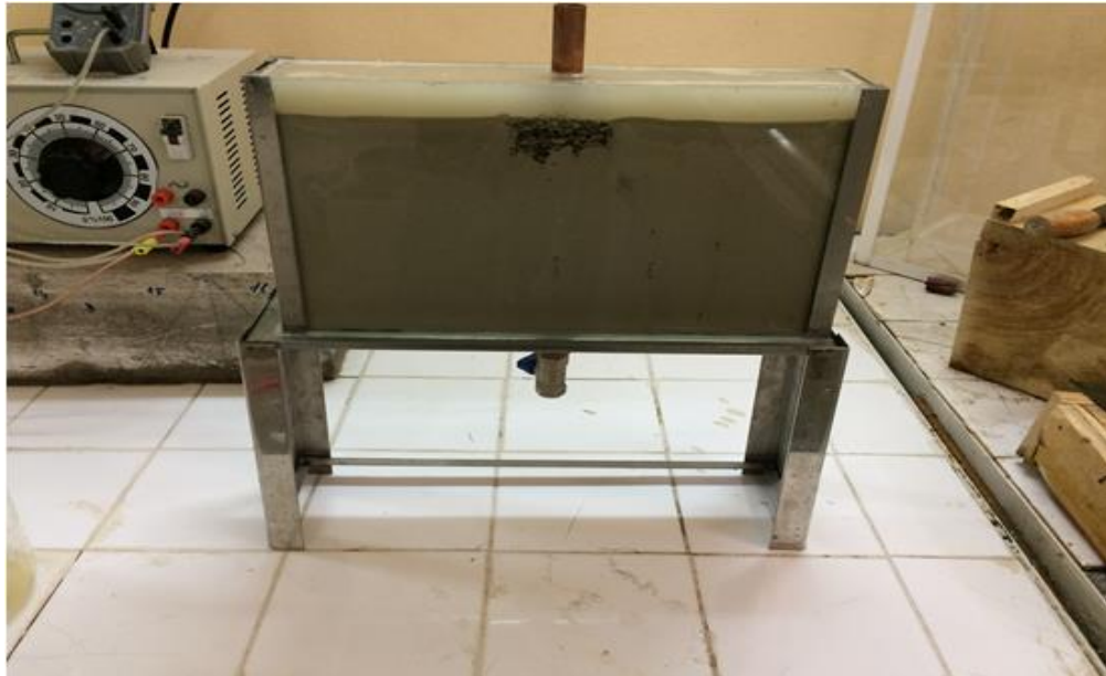
Şekil 3.23 Elektro-osmoz deneyinde kullanılan malzemelerin suya doymun hale getirilmesi.
