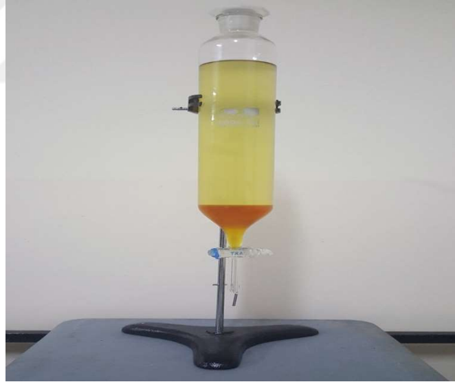
Şekil 2.3 24 saat süresince bekletilmiş biodizel ve gliserin karışımı
