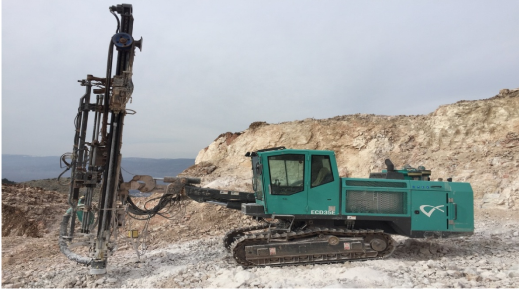
Şekil 3.8 Everdigm ECD 35 E marka kaya delici
