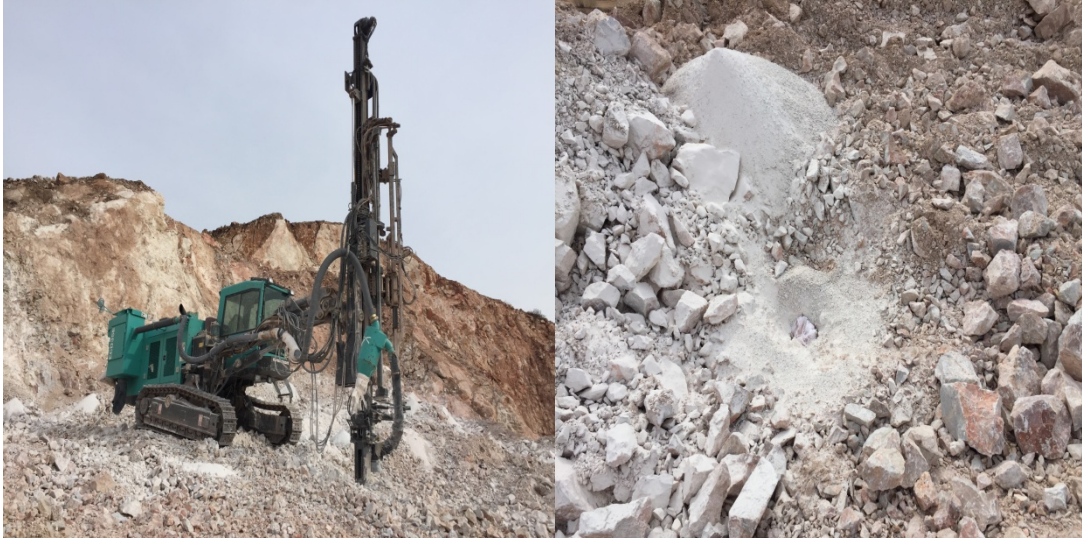
Şekil 3.6 Taş ocağında patlatma deliklerinden bir görünüm
