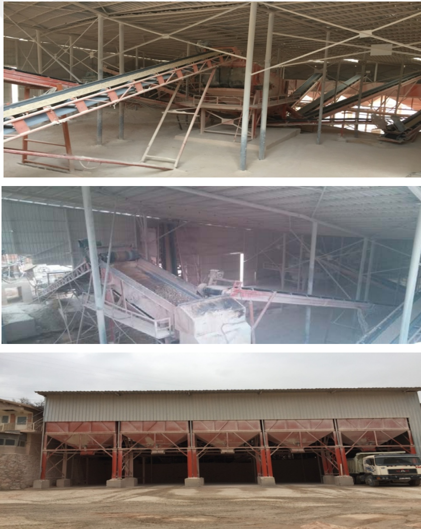
Şekil 3.14 Kırma - eleme tesisi, bant konveyörler ve ürün siloları.
