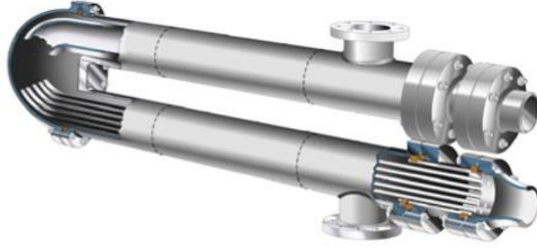
Şekil 2.3 Çift borulu ısı değıştirci (Kaçar ve Erbay, 2013).
