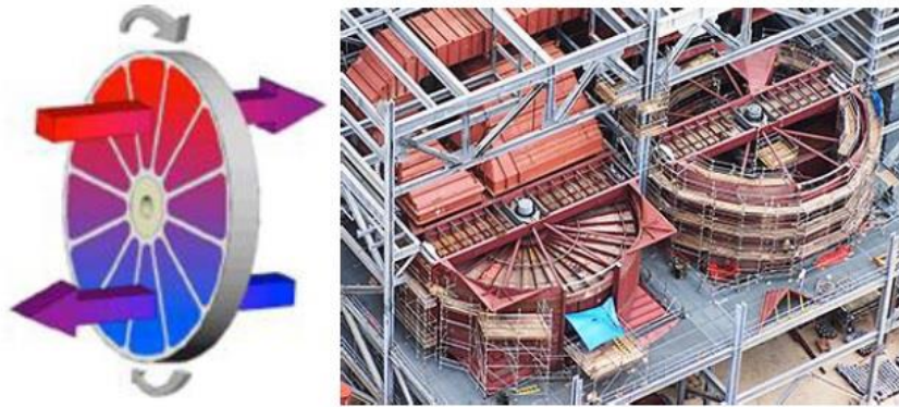
Őekil 2.2 Dner rejeneratif ısı deđiřtiricisi (Shah vd, 2003).
