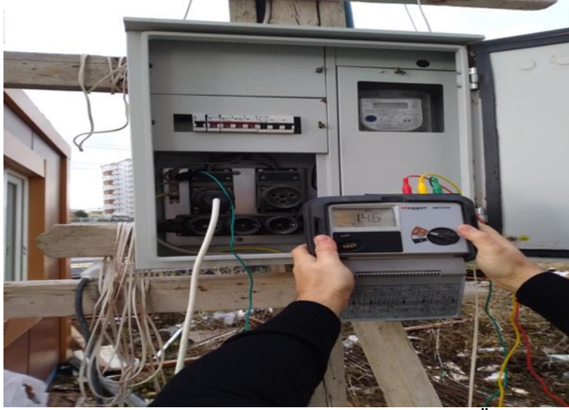
Şekil 4.30 Şantiye Panosunda Topraklama Direnç Ölçümü
