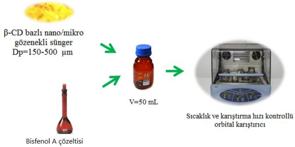
Şekil 3.2 BPA'nın β-CD bazlı nano/mikro gözenekli süngerlere adsorpsiyon süreci.
