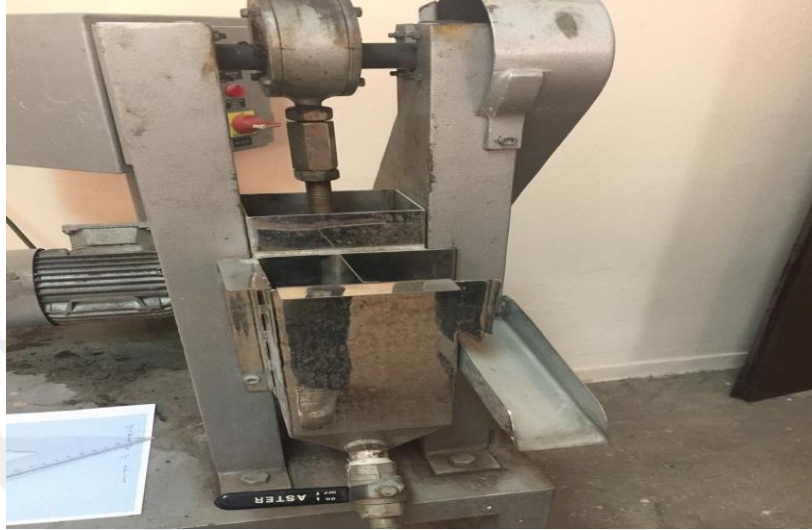
Şekil 3.19 Deneyde kullanılan Harz tipi Jig
