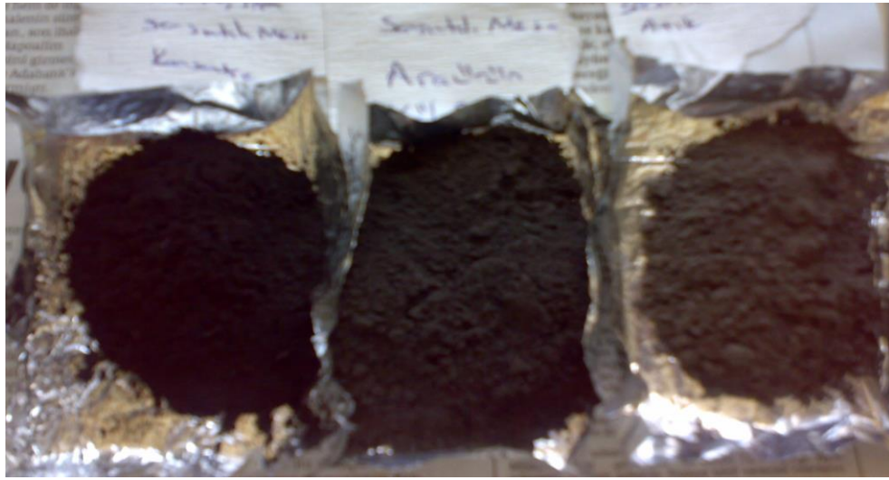
Şekil 3.18 Sarsıntılı masadan çıkan konsantre - ara ürün - atık örnekleri
