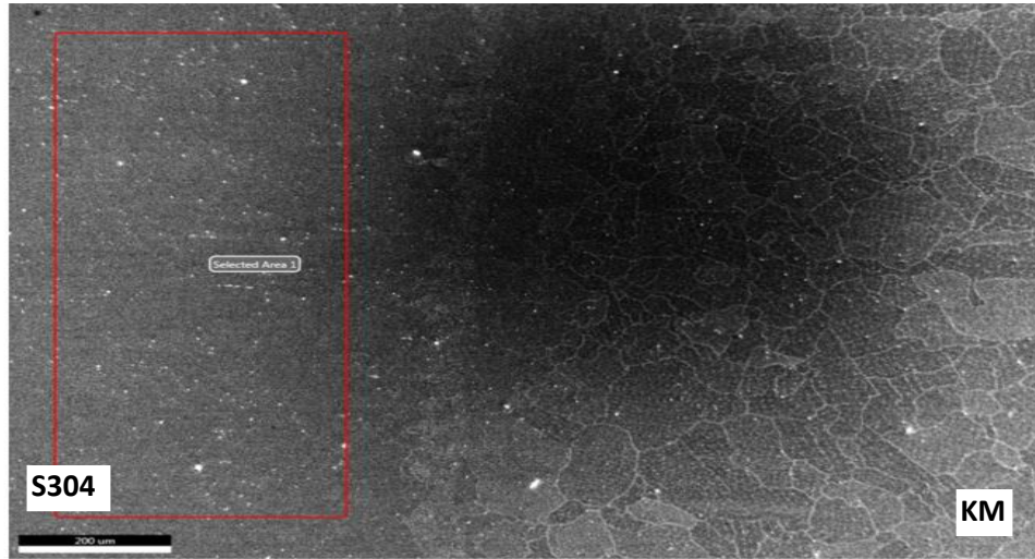
Şekil 3.27: 4. Malzeme çiftinin X5CrNi18-10 (S304) malzemesinin EDS analizini gösteren SEM.
