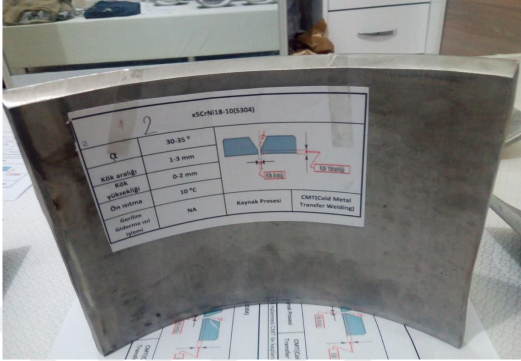
Şekil 2.3: 2 No'lu S304 malzemesine 30 -35° V Kaynak ağızı.
