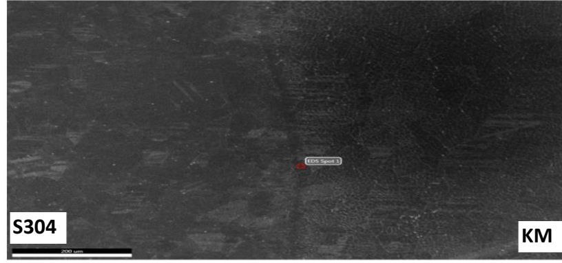
Şekil 3.52: 2. Malzeme çiftinin X5CrNi18-10 (S304) – KM'nin ara yüzeyinin EDS analizini gösteren SEM.
