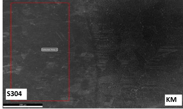
Şekil 3.50: 2. Malzeme çiftinin X5CrNi18-10 (S304) malzemesinin EDS analizini gösteren SEM.
