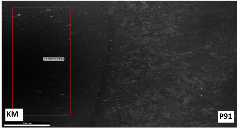
Şekil 3.44: 2. Malzeme çifti X10CrMoVNb9-1 (P91) malzeme tarafı kaynak metalinin EDS analizini gösteren SEM.
