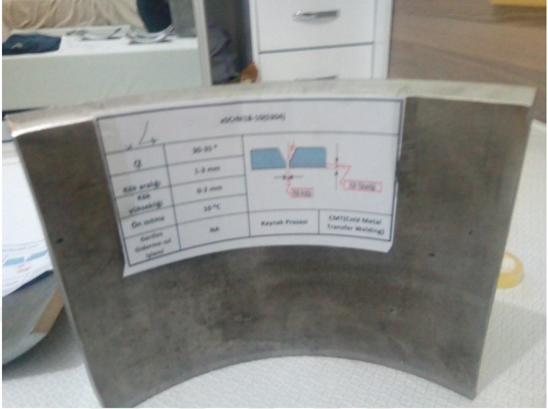
Şekil 2.5: 4 No'lu S304 malzemesine 30 -35° V Kaynak ağızı.
