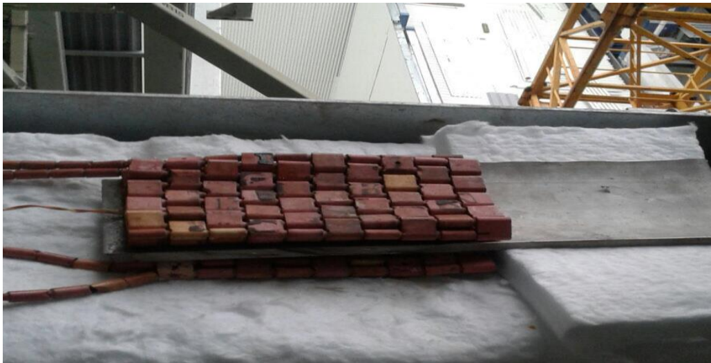
Şekil 2.30: 4. Malzeme çiftinin ısı işlem rezistanslarının bağlanması.
