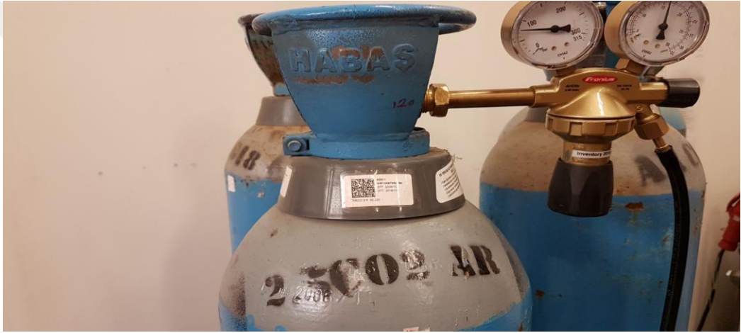
Şekil 2.24: CMT kaynağında kullanılan koruyucu inert gaz(M11)
