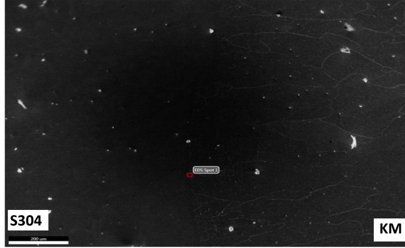
Şekil 3.76: 3. Malzeme çiftinin X5CrNi18-10 (S304) malzemesi-KM ara yüzeyinin eds analizini gösteren SEM.
