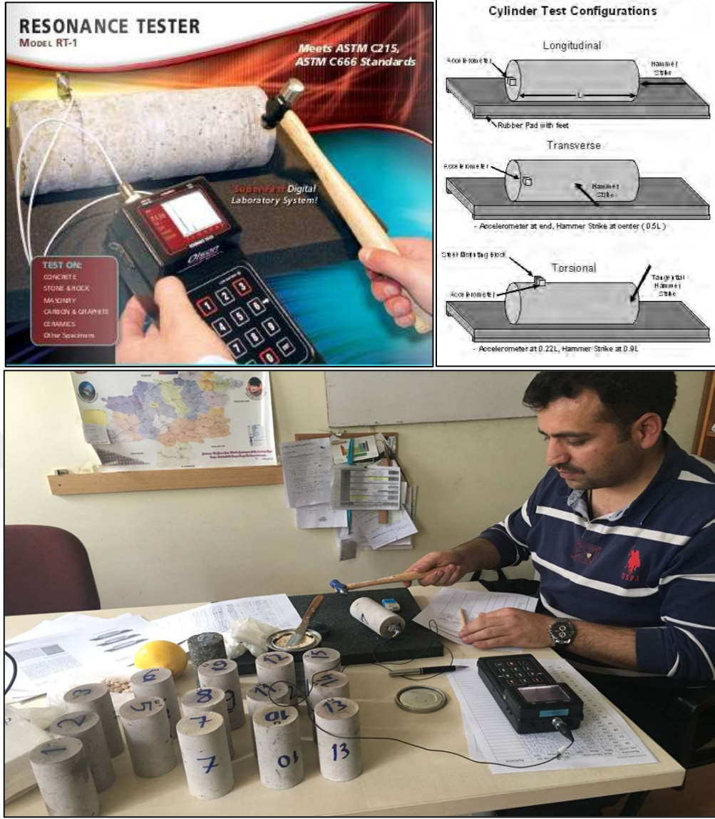
Şekil 3.13 Resonance Tester cihazı ve frekans ölçümü
