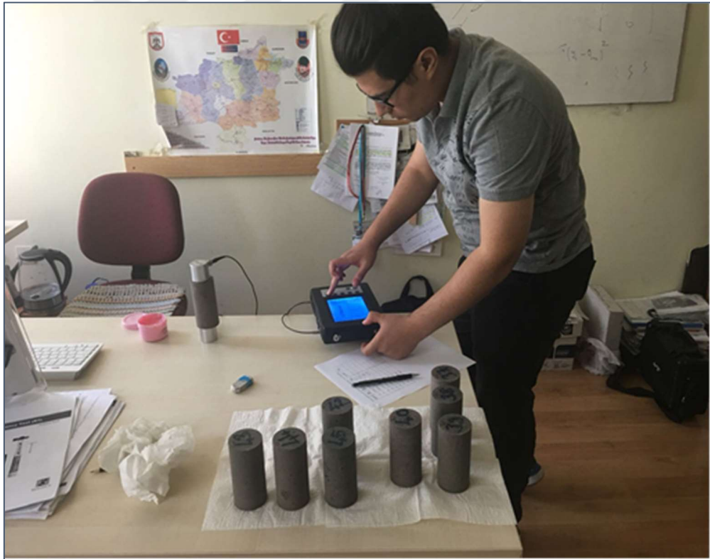
Şekil 3.11 Pundit cihazı ile V_p ölçümü
