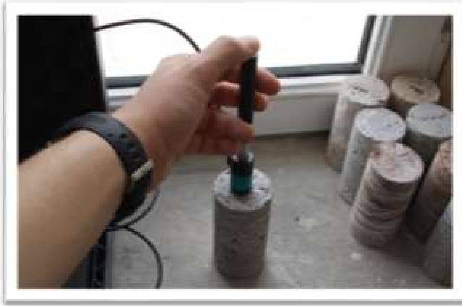
Şekil 3.12 Equotip cihazı ve sertlik ölçümü
