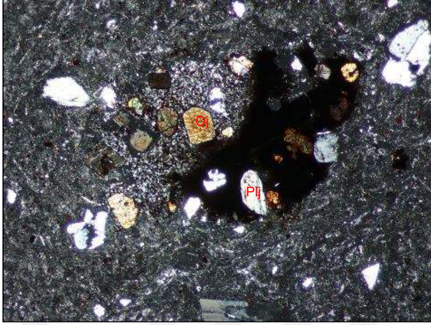
Şekil 3.7 Andezit numunesi ince kesit görüntüsü (Oj: ojit minerali, Plj: plajoklas)
