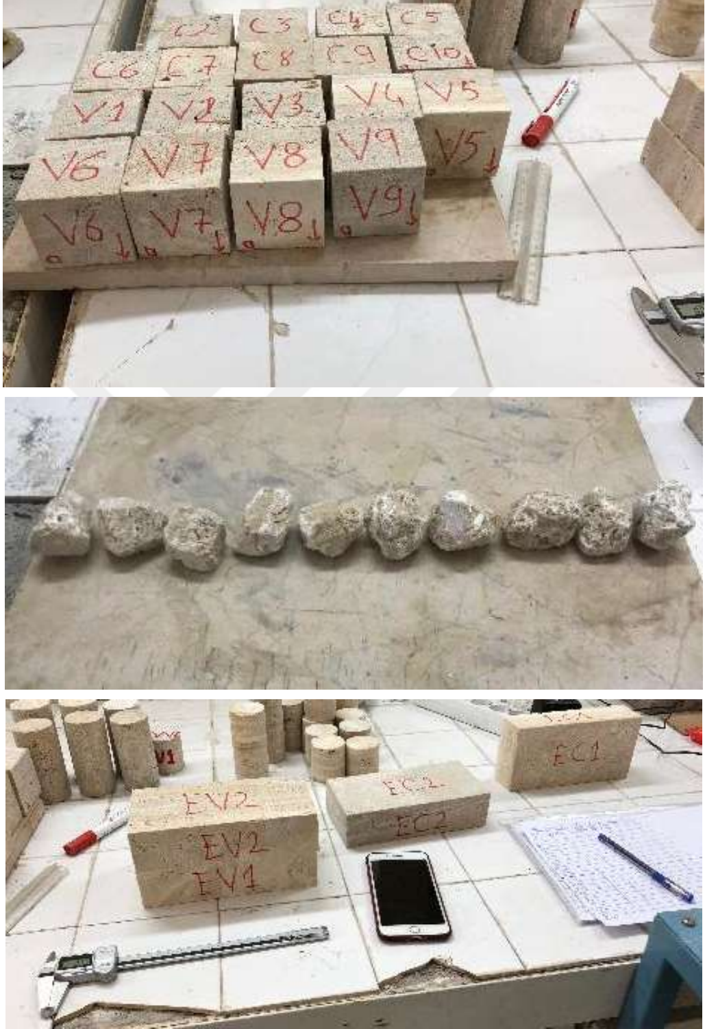
Şekil 3.6 Aşınma Ve Eğilme Deneyleri İçin Hazırlanan Numuneler
