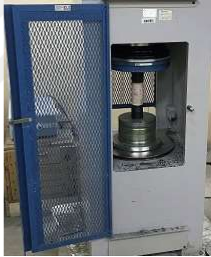
Şekil 3.15. Tek Eksenli Basınç Dayanımı Deney Düzeneği (NX Karot Tipi Numunelerin Kırılması)
