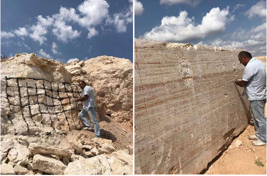
Şekil 3.3 Traverten Ocağında Aynada(Soldaki Resim) Ve Kesilmiş Blok(Sağdaki Resim) Üzerinde Schmidt Sertlik Ölçümü.
