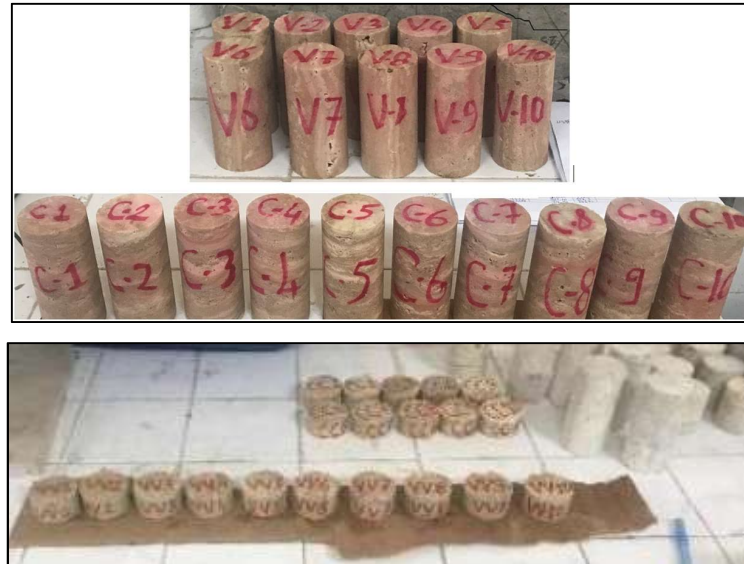
Şekil 3.5 Tabakalanmaya Dik-Vein Cut Ve Tabakalanmaya Paralel-Cross Cut Karot Numuneleri
