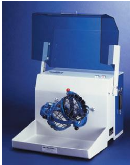
Şekil 4.4 T2F Turbula mikserin şematik görünümü
