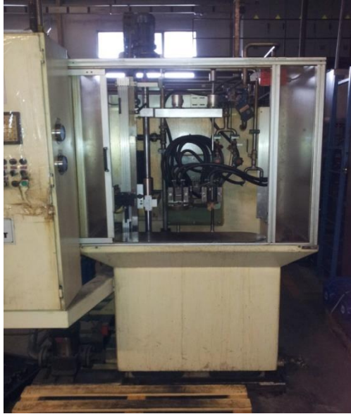
Şekil 4.10 Numunelerin yüzey sertleştirme işlemlerinin gerçekleştirildiği yüksek frekanslı indüksiyon tezgahı
