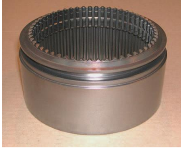
Şekil 3.10 Transfer kutusu kayar maşonu [48].
