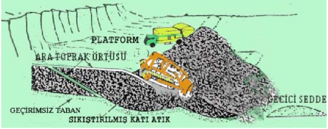
Şekil 4.6 Atıkların dolgu eğiminin aşağısına doğru itilerek serilmesi (Çağlar, 2005).
