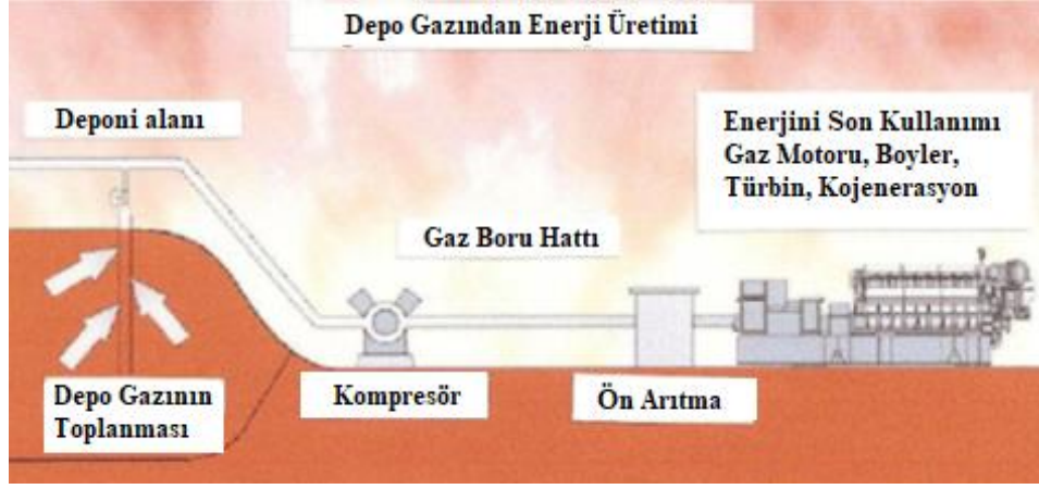
Şekil 5.3 Depo gazından enerji üretim şeması (Solak, 2015).
